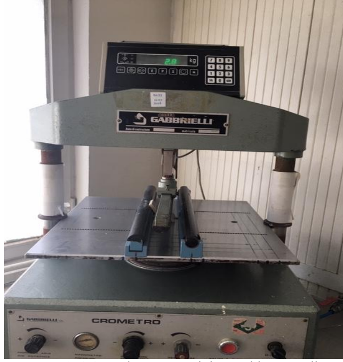
Resim 3.4 Ham karo numunelerinin mukavemet tayinin yapıldığı test cihazı.
