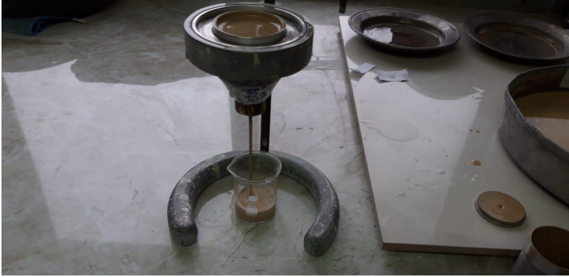
Resim 3.2 Fordcup ile akışkanlık tayini.
