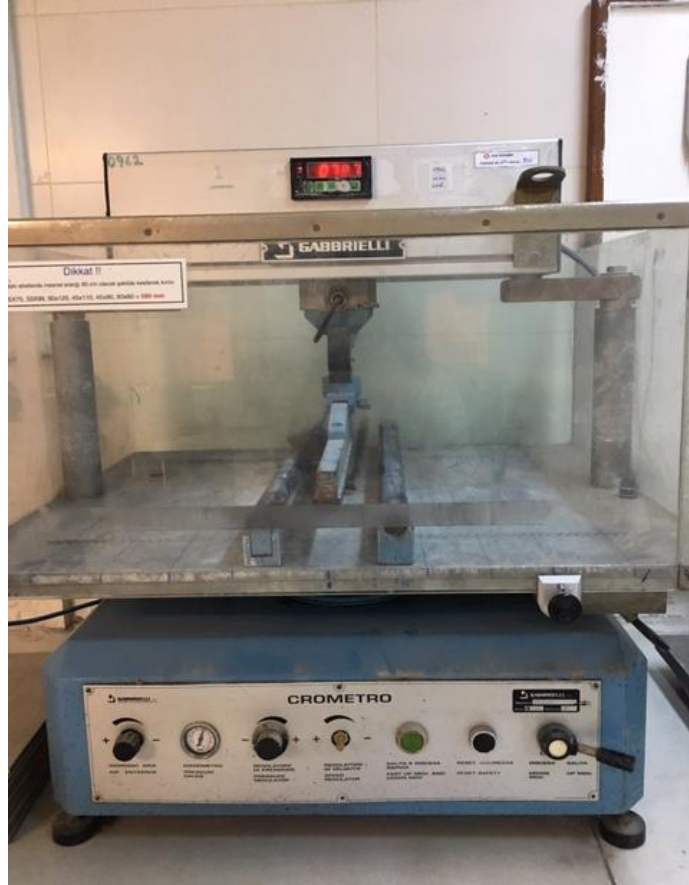
Resim 3.5 Pişmiş karo numunelerinin mukavemet tayinin yapıldığı test cihazı.
