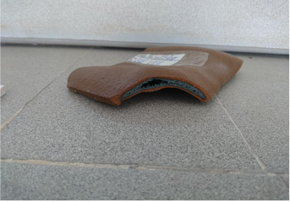
Resim 3.7 Black core örnek görüntüsü.
