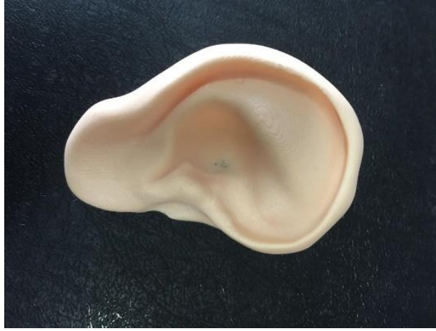
Resim 5.15 3 boyutlu yazıcıdan çıkartılmış sert yapıda kulak numunesi.
