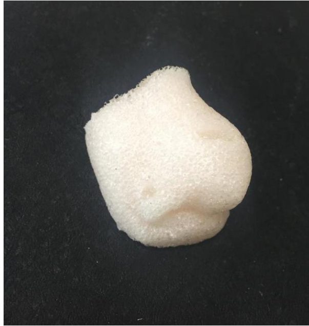
Resim 6.1 RTV830 kiti ile hazırlanmış yumuşak doku implantı.
