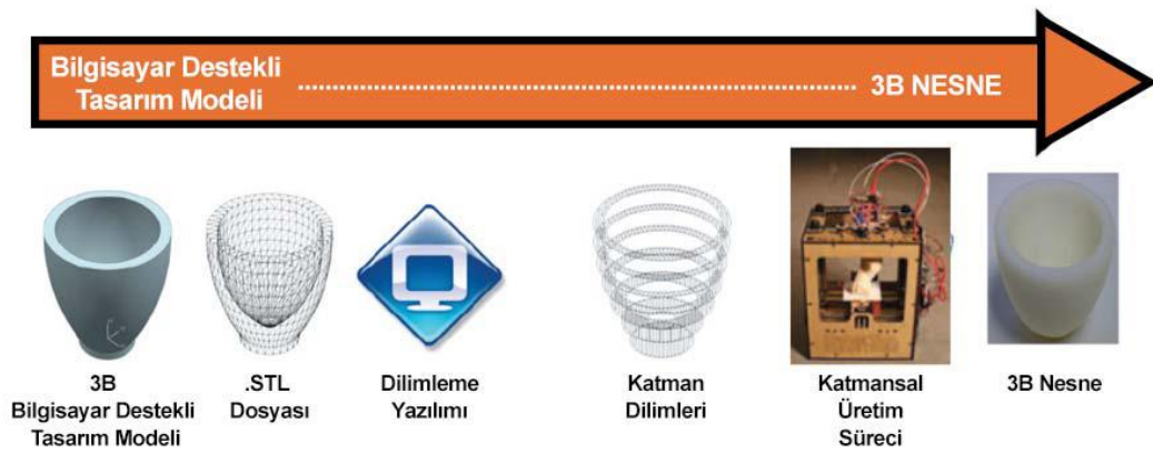
Şekil 4.2 3 boyutlu nesnenin elde edilme aşamaları (Campbell et al. 2011).
