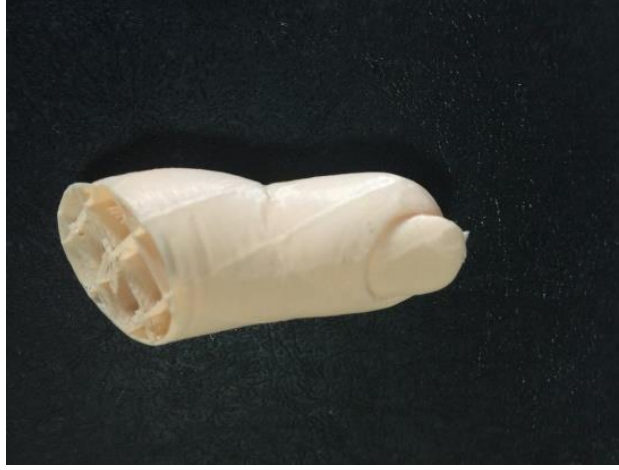
Resim 5.14 3 boyutlu yazıcıdan çıkartılmış sert yapıda parmak numunesi.
