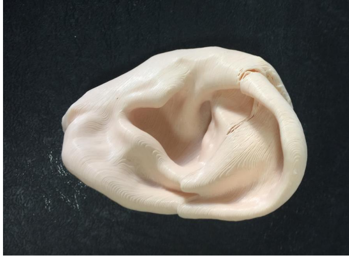
Resim 5.13 3 boyutlu yazıcıdan çıkartılmış sert yapıda kulak numunesi.
