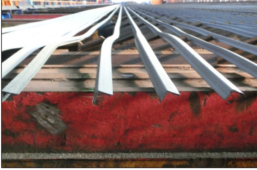
Resim 2.15 Kafaları kırılmış olan 25x25x2.2 mm köşebent profili.
