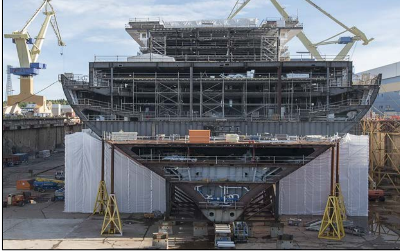
Resim 2.12 Gemi montajı kesit görünümü.
