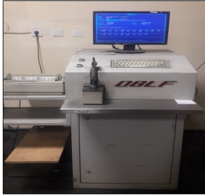
Resim 3.5 OBLF GS 1000 II optik spektrometre cihazı.
