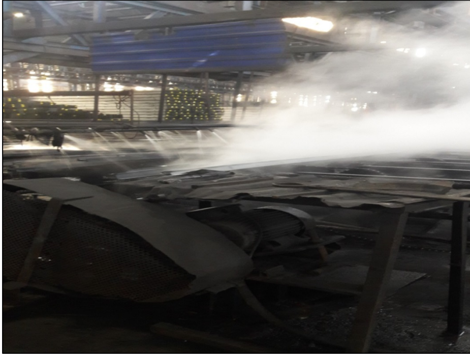
Resim 2.14 Geleneksel yöntemle doğrudan su verme işlemi.
