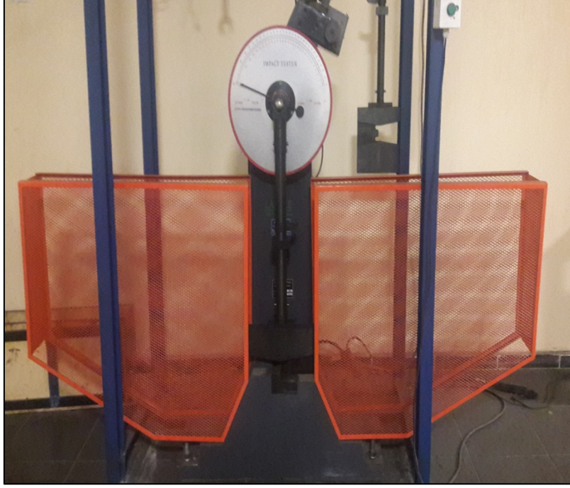
Resim 3.10 JBS 300 B Charpy darbe test cihazı.
