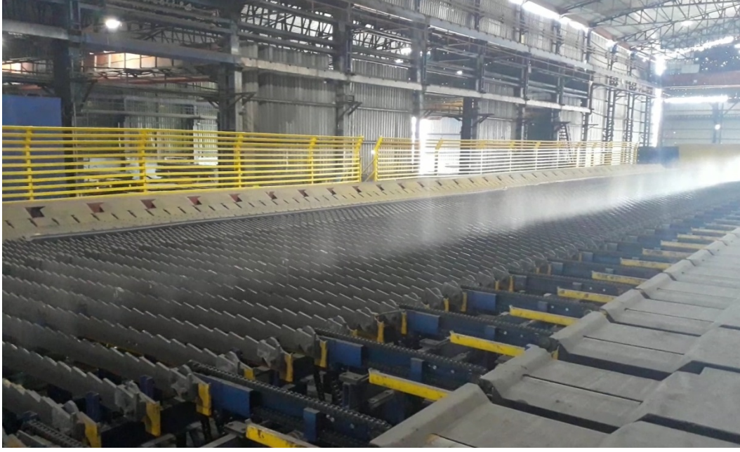
Resim 3.2 KDR 2 numunesine uygulanan soğutma pratiği yer görünümü.
