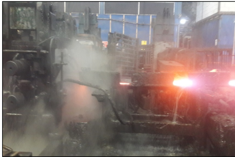
Resim 2.9 Finish tezgahından çıkan demirin ilerleyişi.
