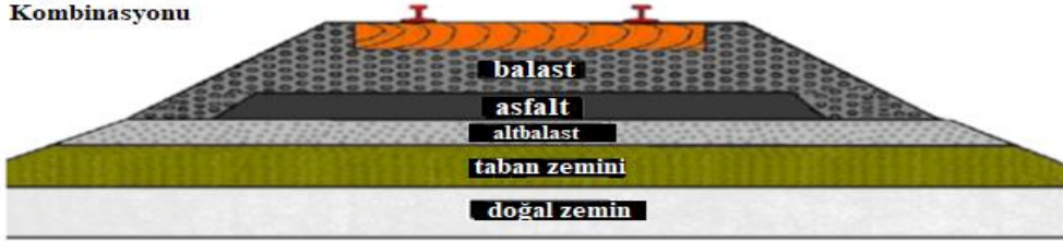
Şekil 2.8 Altbalast tabakasında Asfalt kombinasyonu kullanılmış demiryolu üstyapısı.
