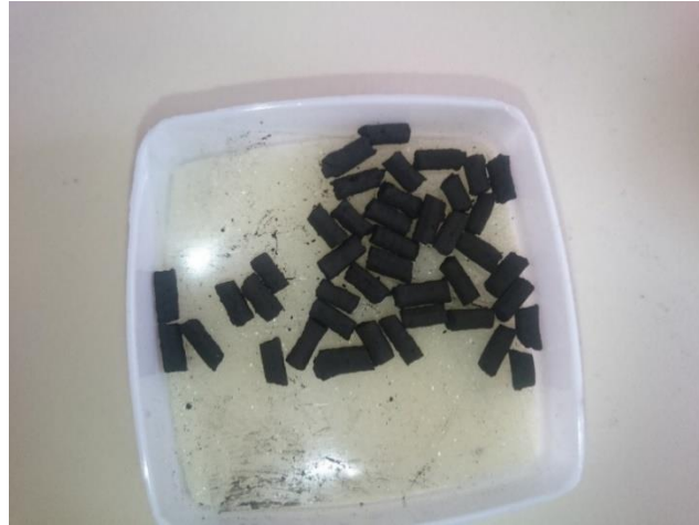
Resim 3.6 Şırınga vasıtası ile 0,3x0,4 cm olacak şekilde boyutlandırılmış numune.
