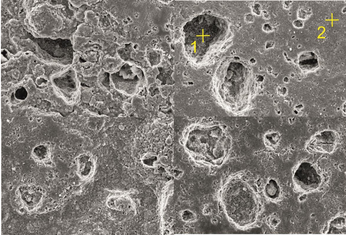
Şekil 4.2 Mag= 1.00 K X büyütme ile numune yüzey görüntüsü ve gözenek dağılımı.
