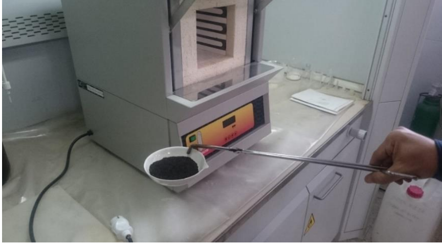
Resim 3.2 5 saat boyunca 450 °C kül fırınında ısıl işleme tabi tutulmuş karışım.
