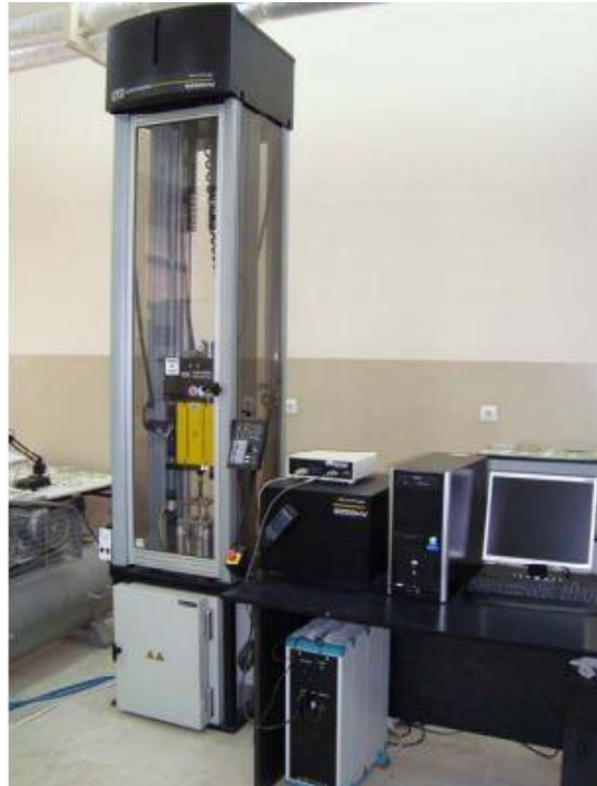
Resim 3.1 Instron-Dynatup 9250 HV darbe dayanım test cihazı.
