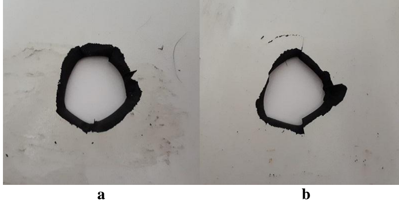
Resim 4.4 T taşıttının ön tampon numunelerinde hıza baęlı oluřan darbe hasarı a) 3 m/s, b) 5 m/s.
