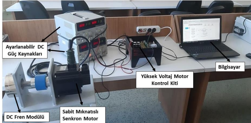
Resim 3.1 SMSM'in kontrolü için deney düzeneği.
