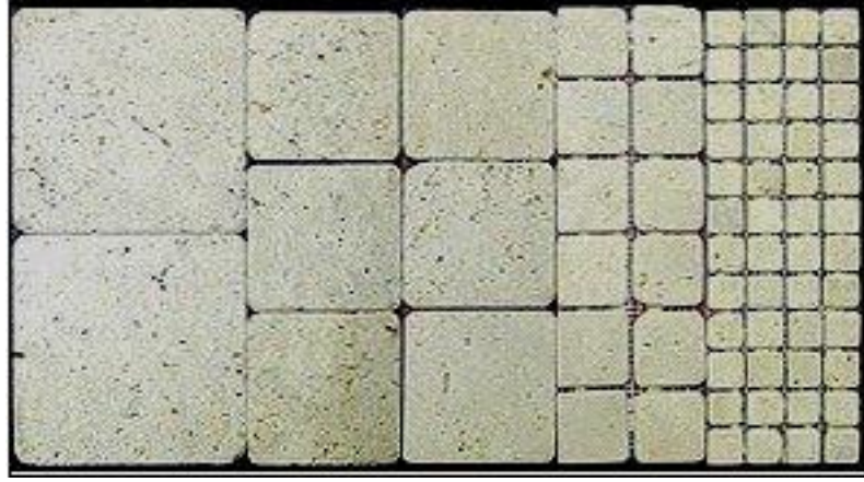
ekil 1. 6x6, 4x4, 2x2 ve 1x1 cm ebatlarında kesilmi düzgün geometrik ekilli mozaikler [4].
