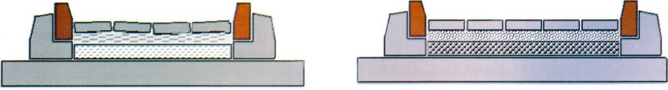
Şekil 4. Killi ve siltli bir zeminin diğerine göre su alarak deforme olmasının parke taşına etkisi.
