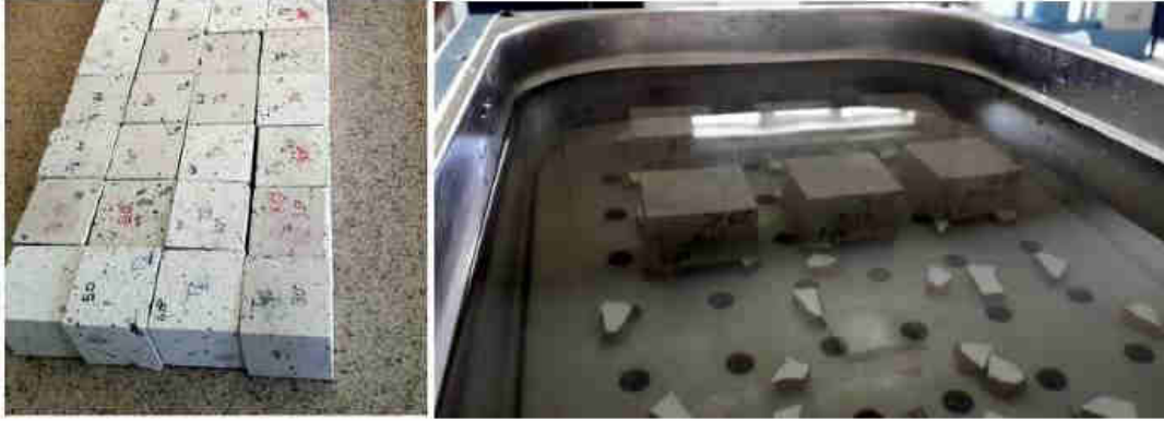
Şekil 3. Su emme deneyi yapılan örnekler ve su banyosu deney seti
