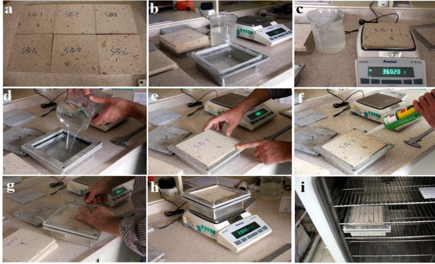
Şekil 3. Su buharı aktarım özelliklerinin belirlenmesi deney örneklerinin görünümü ve deneye hazırlama aşamaları
