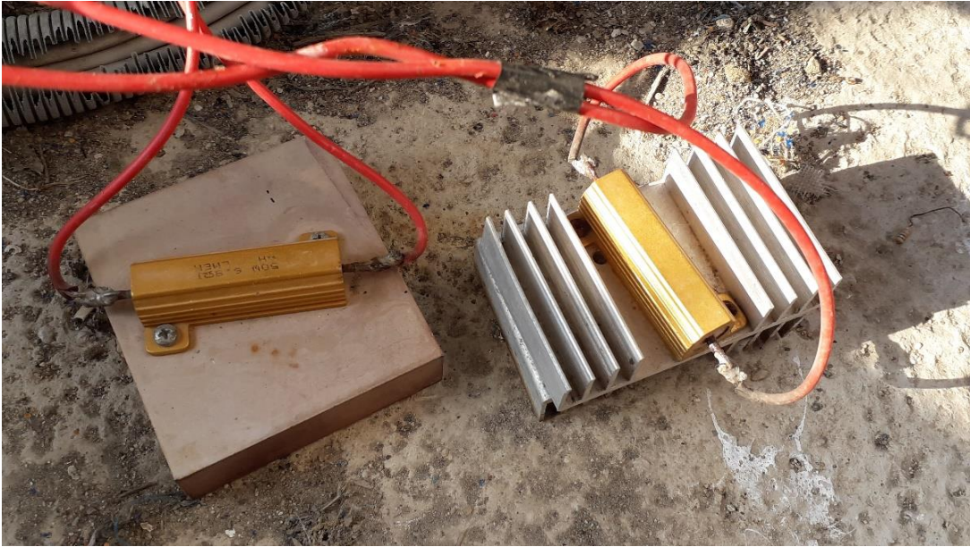
Resim 3.2 Panel Uçlarındaki Alüminyum Soğutuculara Bağlı Yükler.
