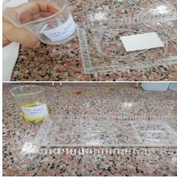
Şekil 3.10 TiO_2 , SiO_2 , B_2O_3 ve TiO_2 + SiO_2 + B_2O_3 Sol – Jel Daldırma Yöntemi ile Kaplama.
