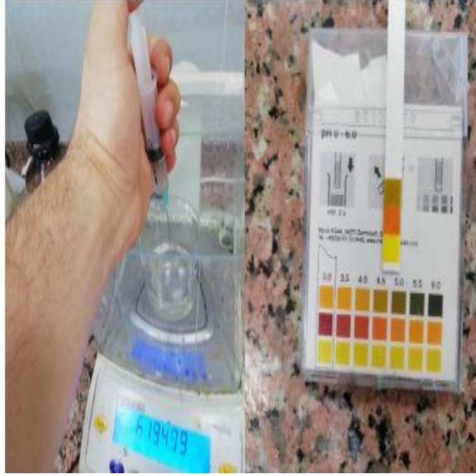
Şekil 3.6 TiO 2 Kaplama Karışımının Hazırlığı ve pH Ölçümü.
