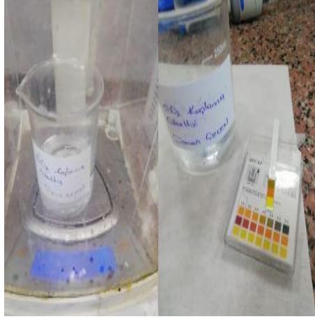
Şekil 3.7 SiO 2 Kaplama Karışımının Hazırlığı ve pH Ölçümü.
