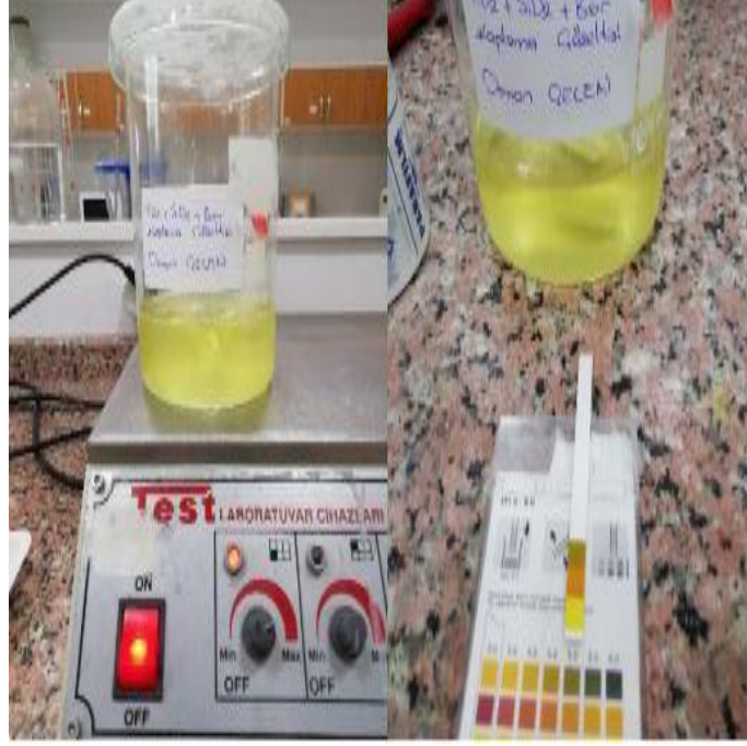
Şekil 3.8 TiO_2 + SiO_2 + B_2O_3 Kaplama Karışımının Hazırlığı ve pH Derecesi.
