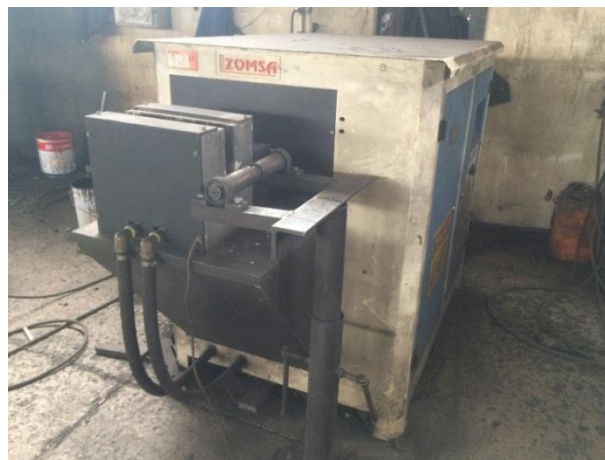
Resim 3.9 Sertleştirme işlemi için numunelerin ısıtılmasında kullanılan İzomsa marka indüksiyon makinası.
