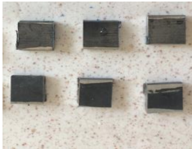
Resim 3.17 Zımparalama ve yüzey parlatma işlemi için hazırlanan çelik numuneler.
