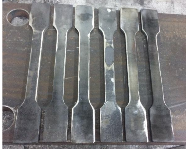
Resim 3.16 Isıl işleme tabi tutulan çelik numuneler.
