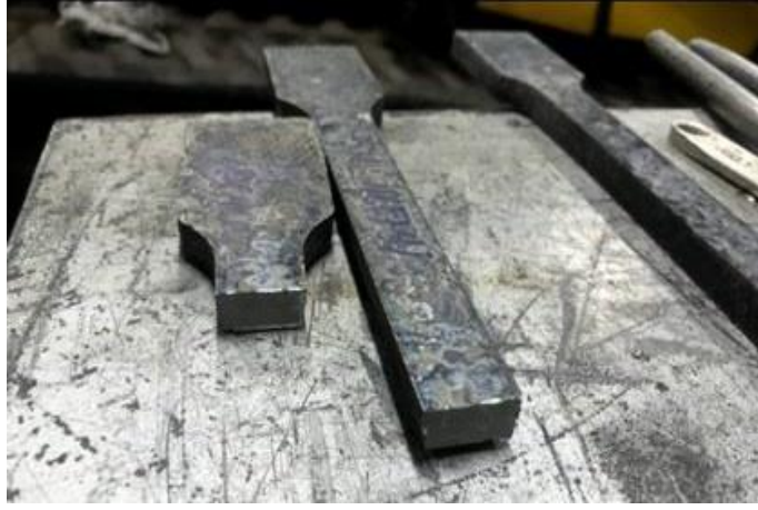
Resim 4.6 Çekme testi sonrası hasara uğrayan örnek numune.
