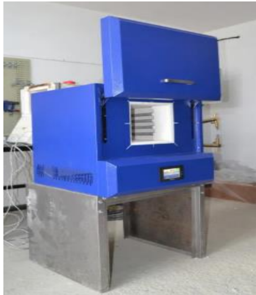
Resim 3.15 Temperleme ısıl işleminin yapıldığı numune fırını.
