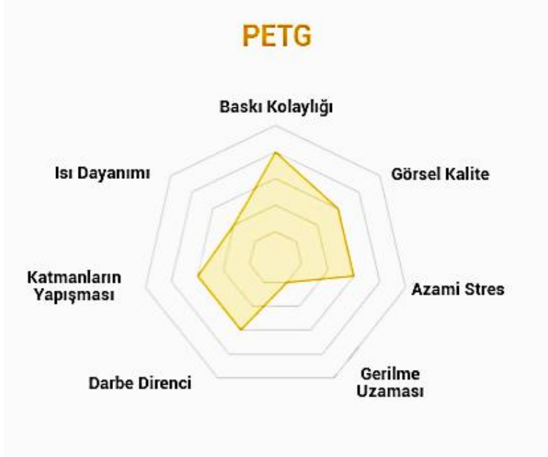
Şekil 2.6 PETG filamentinin özelliklerinin şekil üzerinde gösterimi (İnt.Kyn.4).
