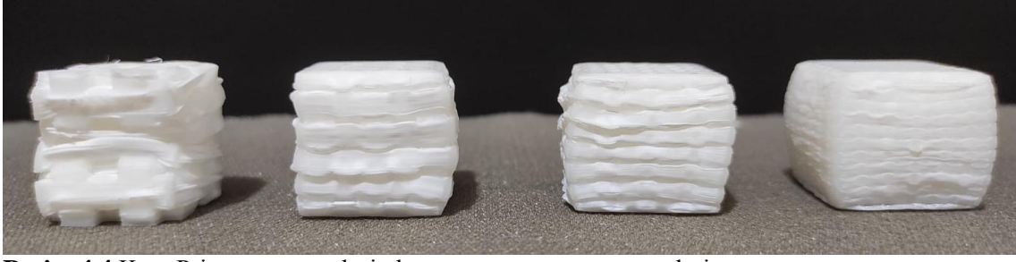
Resim 4.4 Kare Prizma numunelerin basma test sonrası görüntüleri.
