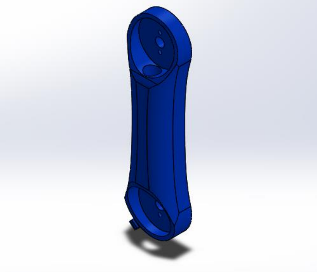
Şekil 5.6 Manipülatorün 2. eksen izometrik görünümü.
