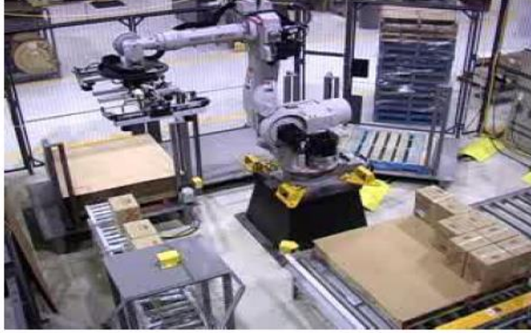
Resim 2.3 Vakumlu tutucunun uygulandığı endüstriyel robot sistemi.
