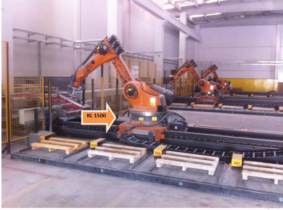
Resim 2.1 Manipülatöre montajı yapılmış track.
