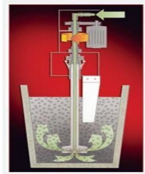
Şekil 2.8 Döner tip parçacık gaz giderme sistemi (Puga et al. 2009).
