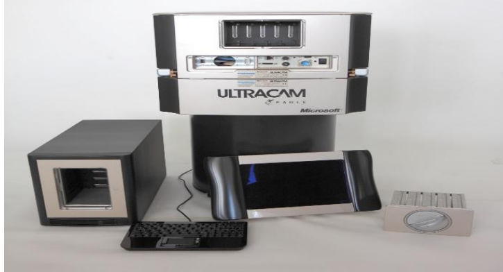
Şekil 3.1 Sayısal Hava Kamerası (İnt.Kyn.3).
