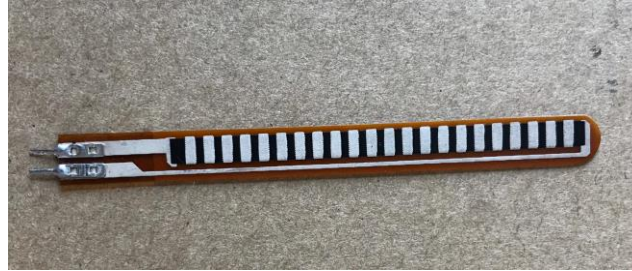
Resim 3.1 5.5 cm uzunluğunda esneklik algılayıcı.
