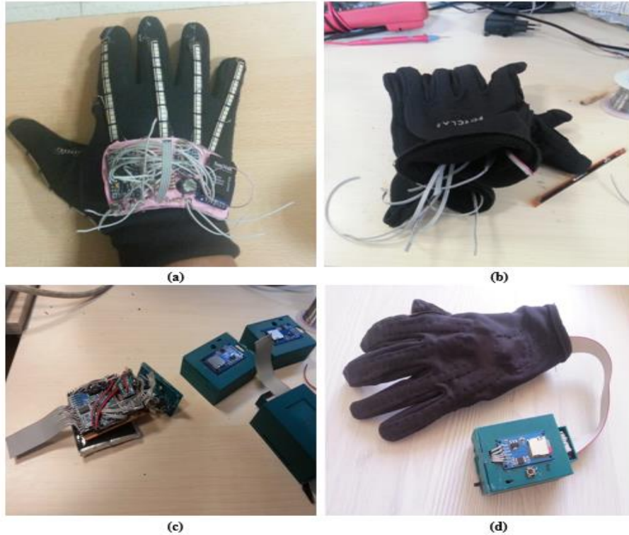
Resim 3.11 (a); Prototip çalışması, (b); Eldivenlere algılayıcıların montajı ve kablolama, (c); Eldivendeki algılayıcılar için kontrol birimi, (d); Çalışmada tasarlanan sol eldiven.
