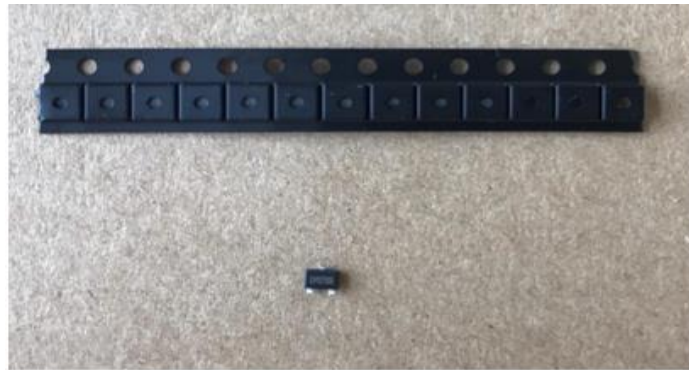
Resim 3.3 Çalışmada kullanılan manyetik alan algılayıcı.
