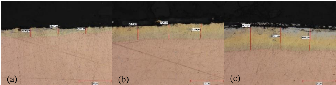
Resim 6.11 Fe 3 Al kaplanmış keplerin işlem sonrası mikroyapıları; a) 66V, b) 112V, c) 158V.
