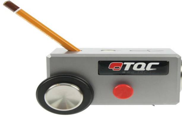
Resim 3.5 Denejde kullanılan TQC kalem sertliđi test cihazı.
