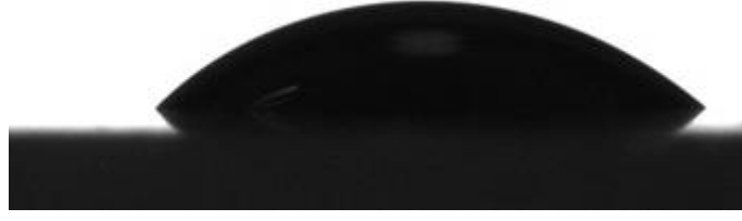
Resim 4.1 İşlem görmemiş mikroskop lam camı temas ölçüm görüntüsü.
