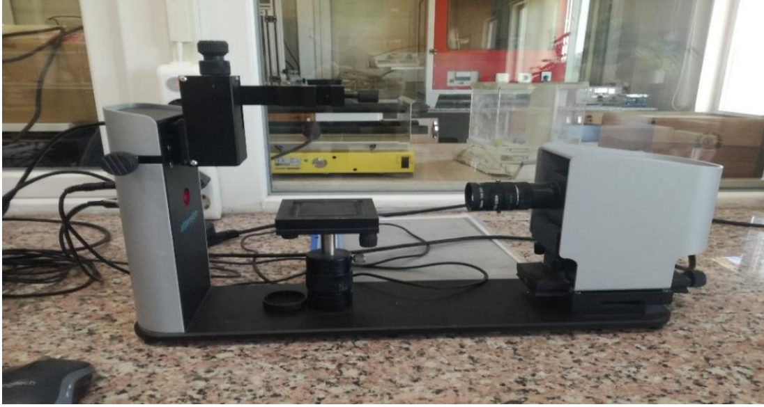
Resim 3.4 Deneyde kullanılan KSV Attension ve ThetaLite TL 101 Optical Tensiometer markalı temas açısı ölçüm cihazı.
