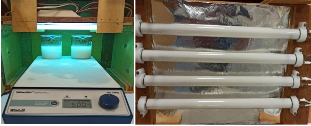
Şekil 3.2 Fotokatalitik deney sistemi ve bu sistemde kullanılan lambaların resimleri.
