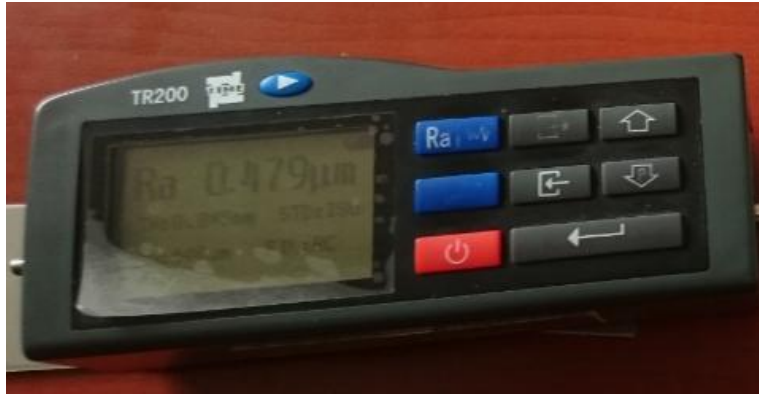
Resim 3.11 Phynix Manuel TR200 yüzey pürüzlülük ölçüm cihazı.
