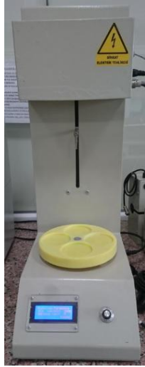
Resim 3.5 Kaplamada kullanılan daldırma kaplama cihazı.
