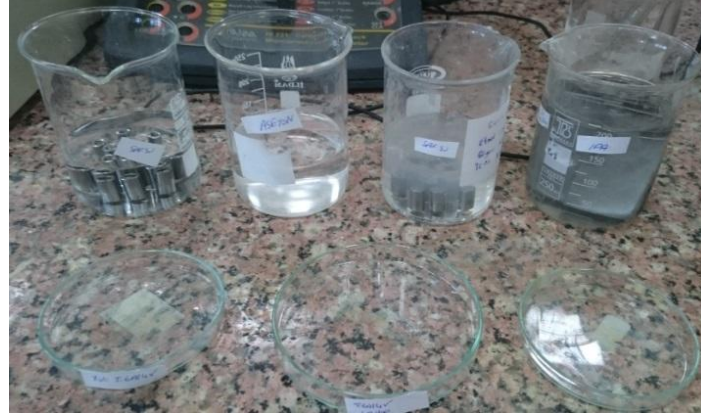
Resim 3.1 Altık malzemelerinin temizlenmesi.
