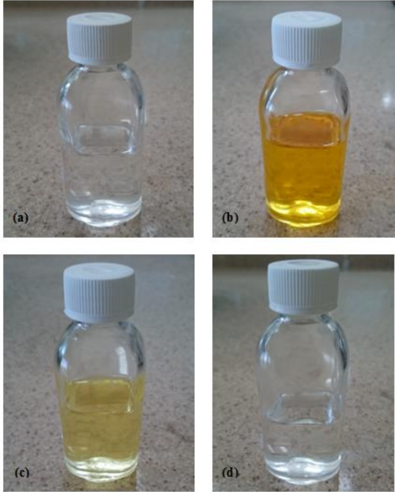
Resim 3.4 GLYMO kullanılarak hazırlanan (a)saf (b)titanyum alkoksit (c)zirkonyum alkoksit ve (d)bor alkoksit katkılı hibrit sollar.
