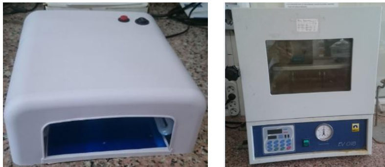
Resim 3.6 UV kürlemede kullanılan UV kurutma cihazı ve termal kürlemede kullanılan nüve EV018 vakumlu etüvü.
