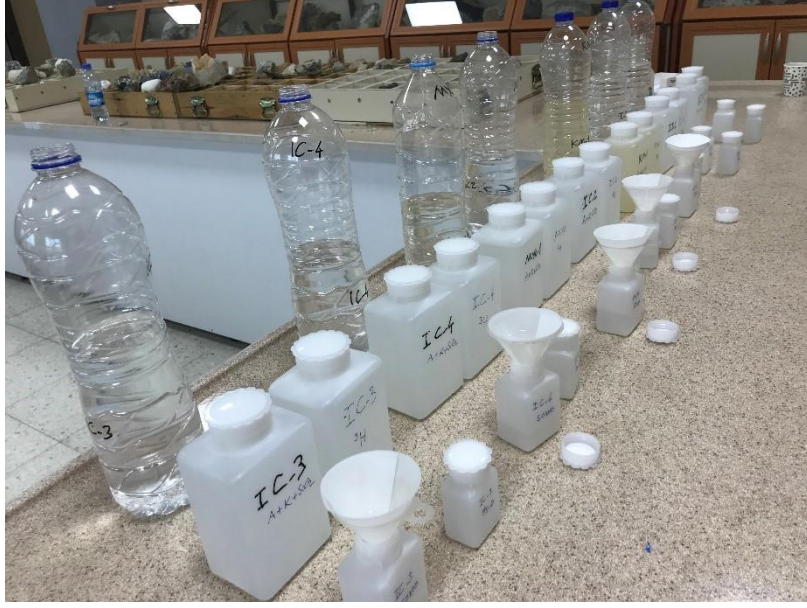
Şekil 3.8: Alınan örneklerin laboratuvarında filtre yardımıyla şişelere aktarılması.
