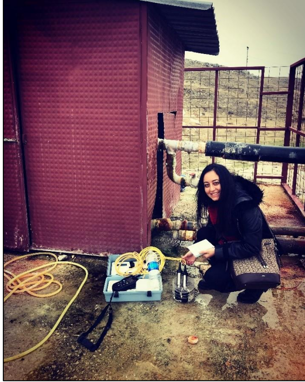
Şekil 3.3 Hach Lange H40QD marka su ölçüm cihazı ile yerinde ölçüm çalışmaları.
