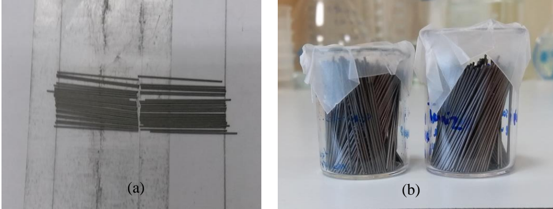
Resim 3.3 (a) Kalem uçlarının ortadan ikiye bölünmesi , (b) ölçümler için hazır olan kalem uçları.
