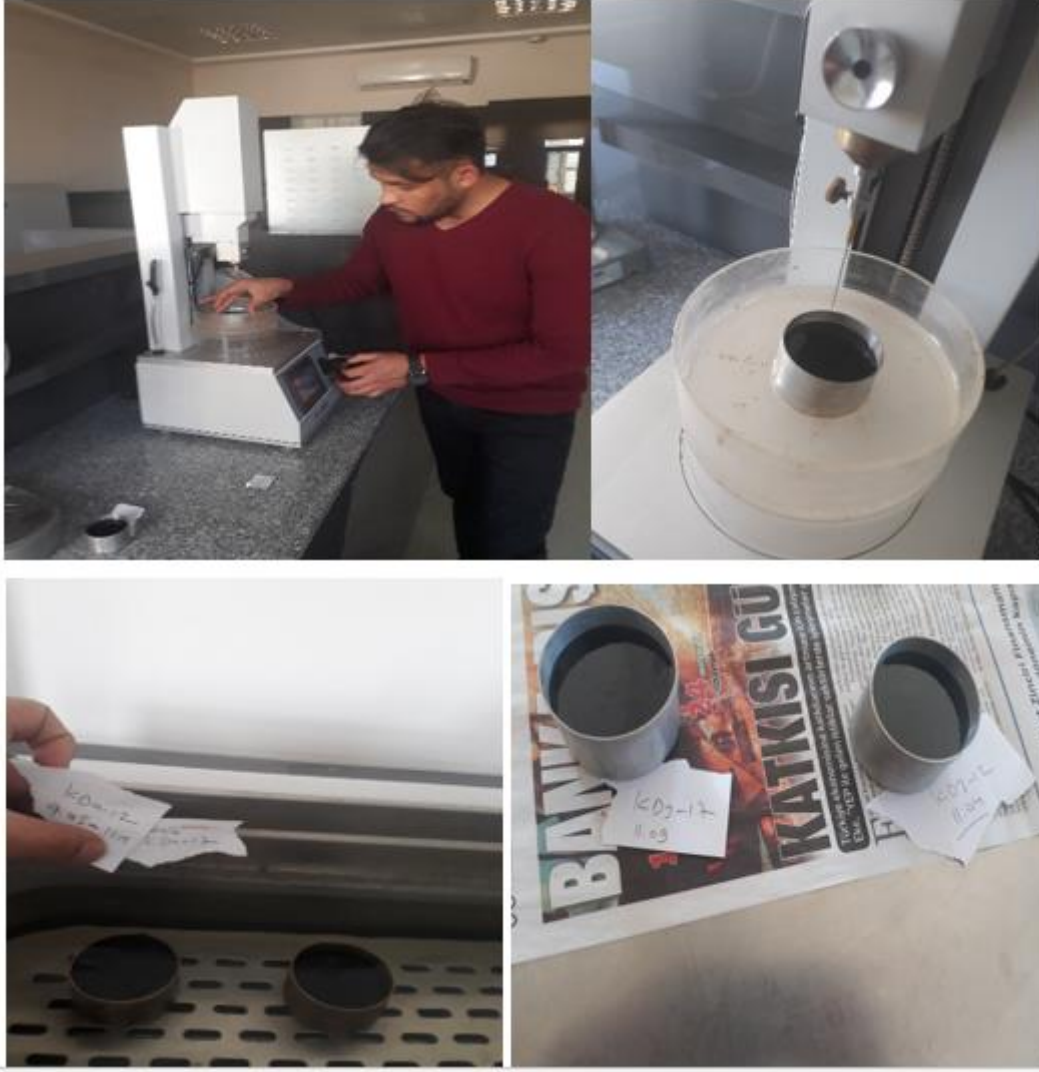
Resim 3.8 Bitüm penetrasyon deneyi aşamaları.
