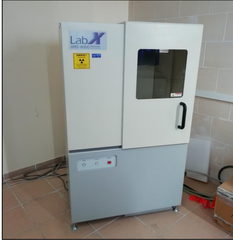
Resim 3.5 Shimadzu XRD-6000 model X-ışını difraktometre cihazı.
