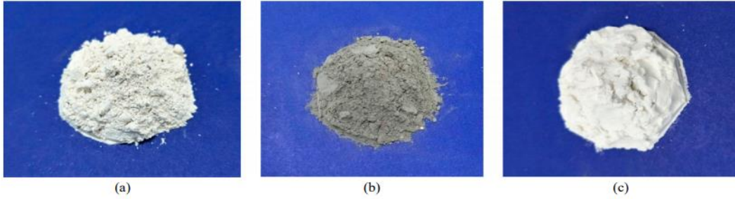
Resim 2.3 Farklı dolgu türleri (a) hidratlanmış kireç, (b) çimento ve (c) diyatomit (shukry vd. 2018).
