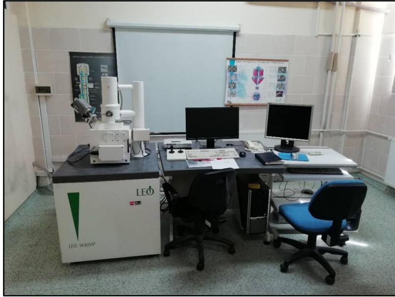
Resim 3.4 LEO VP-1431 model taramalı elektron mikroskobu.
