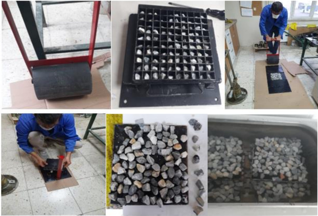
Resim 3.13 Vialit deney aparatları, numunelerin üretimi ve çelik bilya düşürülerek deneyin yapılması.
