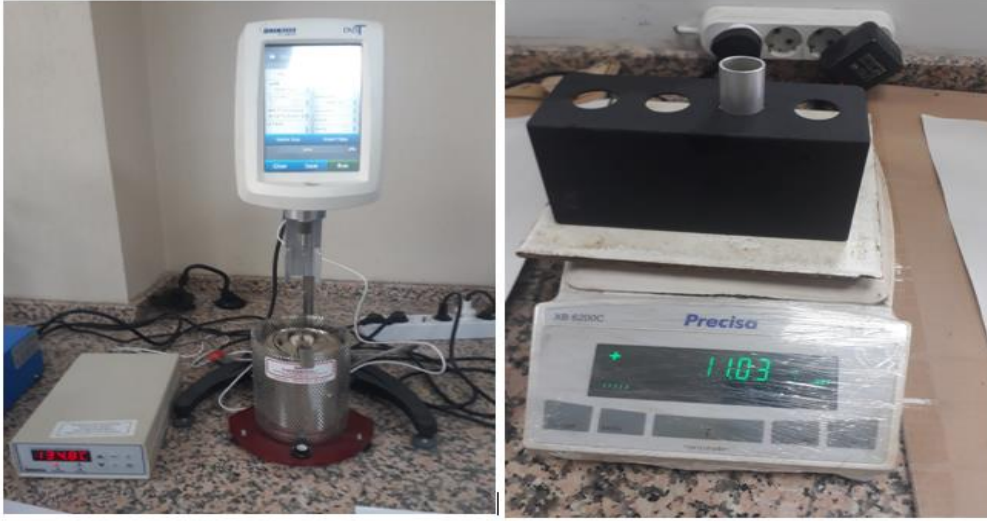
Resim 3.10 Dönel (Brookfield) viskozimetre (RV) deney cihazı (AKÜ İnşaat MÜH LAB).
