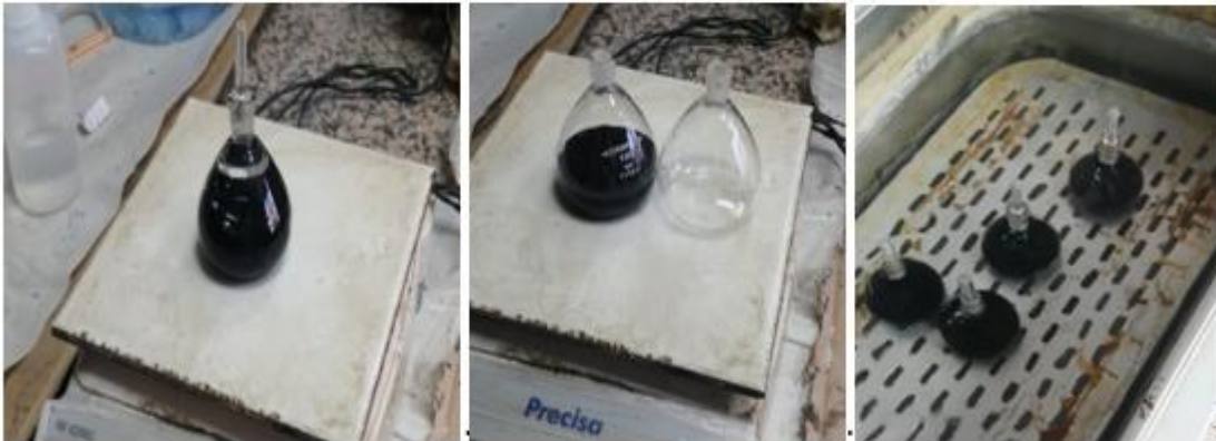
Resim 3.7 Bitüm özgül ağırlık piknometresi deney aşamaları.
