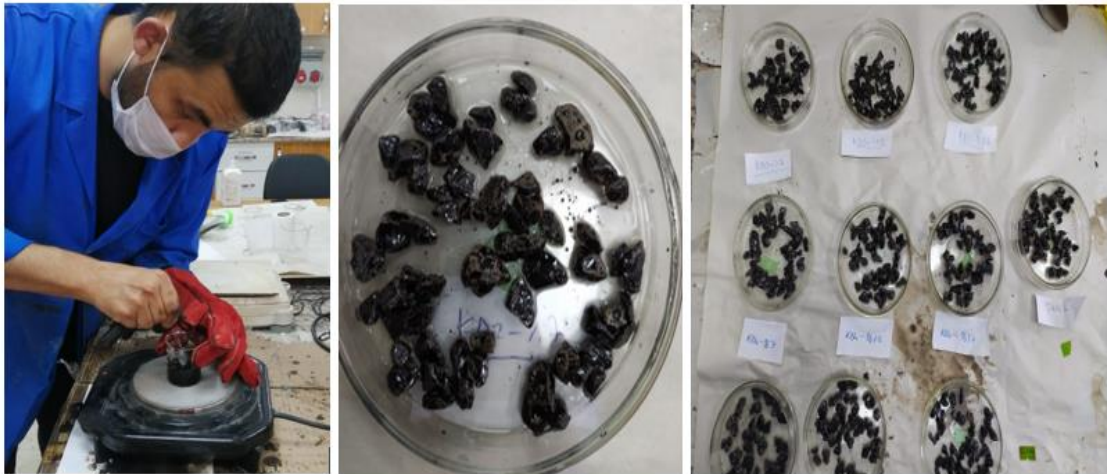
Resim 3.14 Nicholson soyulma deneyi numunelerinin hazırlanması.
