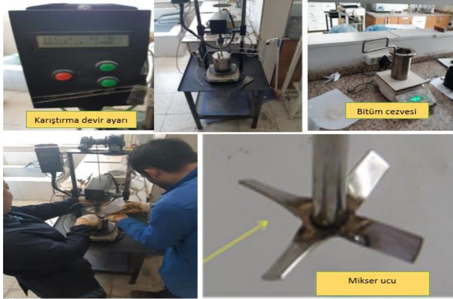
Resim 3.3 Sıcaklık ve devir kontrollü modifiye bitüm mikseri.
