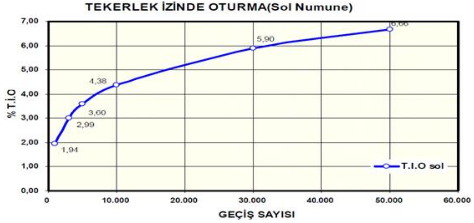
Şekil 2.3 Diatomit katkıli tekerlek izinde oturma numunesi (sağ tekerlek) üzerinde oluşan tio %'si miktarı (Kaşak, 2007).
