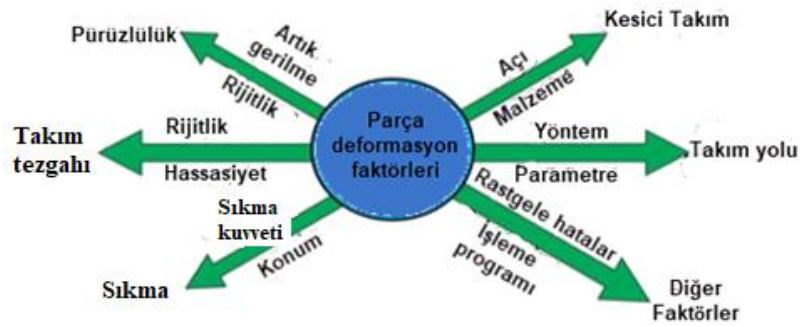
Şekil 2.6 İnce duvar doğruluğunu etkileyen faktörler (Bing vd.2015).
