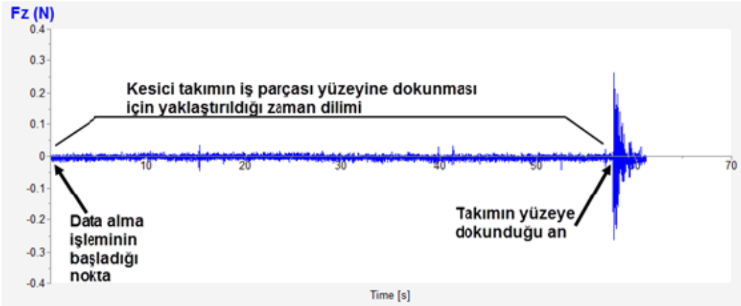
Resim 3.2 Kesici takımın iş parçası yüzeyine sıfırlanması sırasında kullanılan Fz kuvveti değişim sinyalleri.
