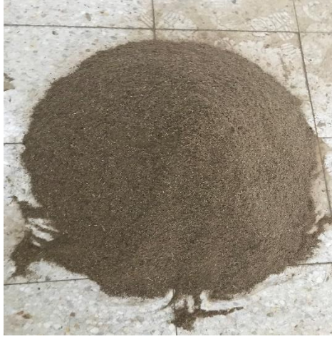
Resim 3.7 0-2 mm arasında elenmiş numune.
