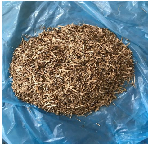
Resim 3.9 4-6,3 mm arasında elenmiş numune.
