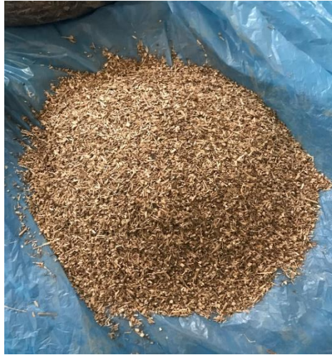
Resim 3.8 2-4 mm arasında elenmiş numune.
