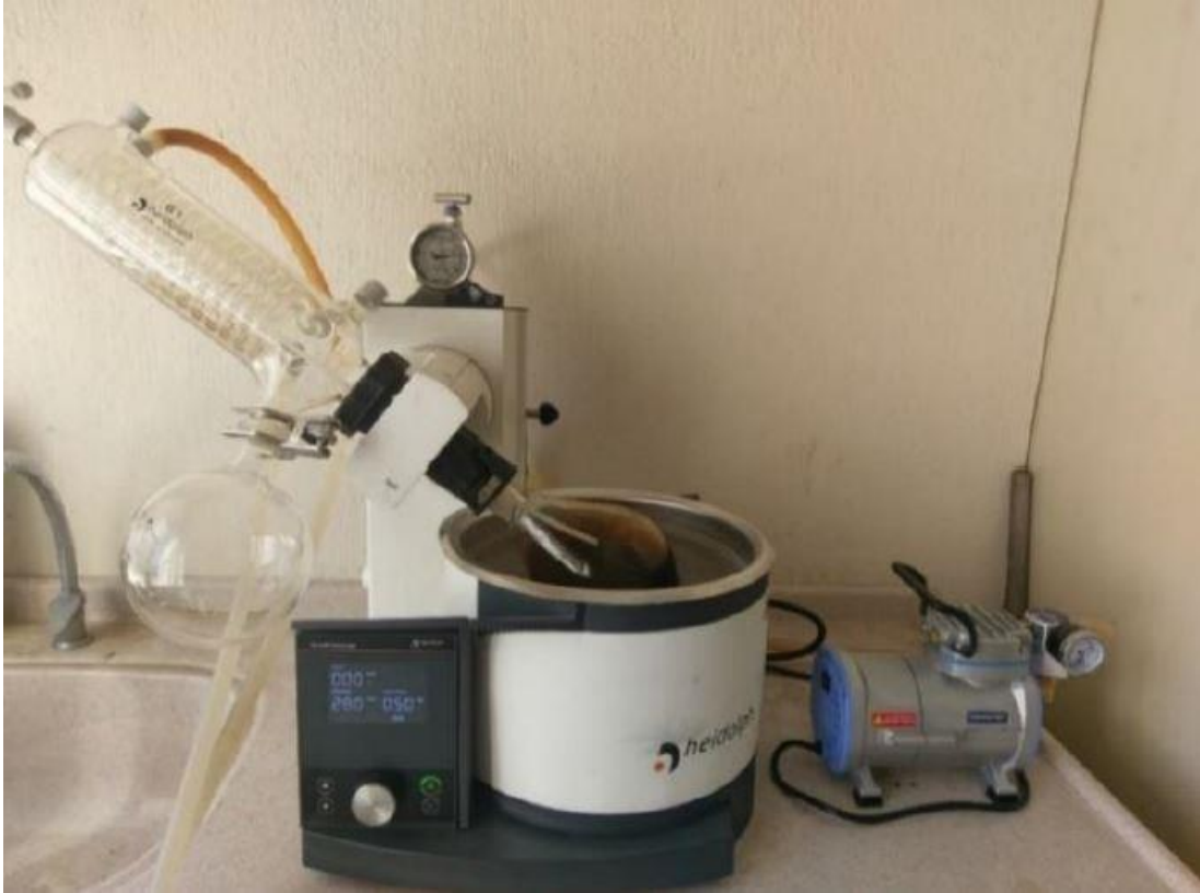
Resim 3.13 Evaporatör ile diklorometanı uzaklaştırma işlemi.
