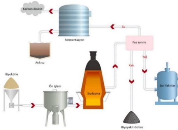
Şekil 1.13 Biyokütle sıvılaştırma şeması (Tursi 2019).
