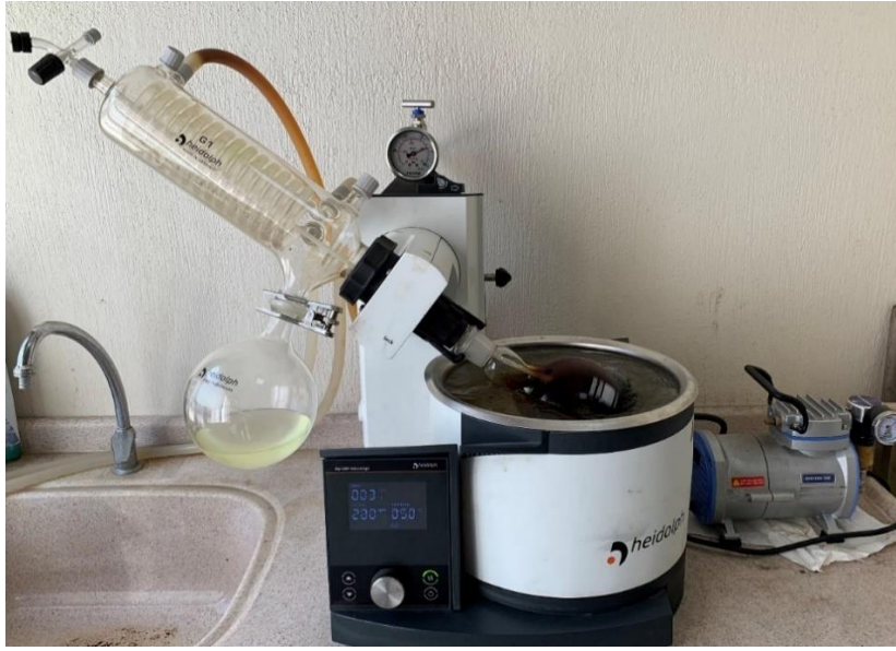
Resim 3.6 Döner buharlaştırıcı (rotary evaporator) ile ayırma işlemi.
