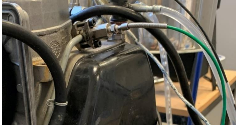
Resim 3.17 Yakıt hattı kelepçe adaptörü ve piezo dirençli basınç sensörü.
