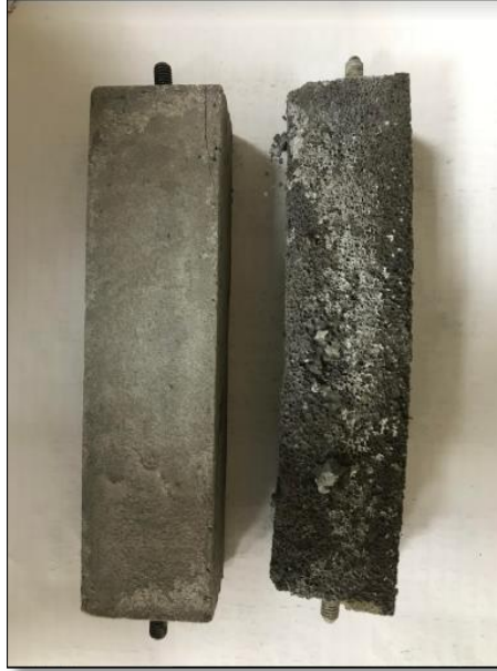
Şekil 3.3 Uçucu kül esaslı, metakaolen (solda) ve yüksek fırın cürufu (sağda) içeren numunelerin rötre için hazırlanan prizmatik numuneleri.
