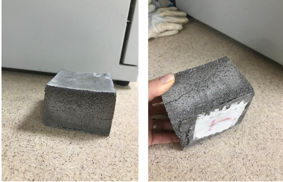
Şekil 3.4 Tamamen uçucu kül ile hazırlanan numunelerde gözlemlenen çökme ve çatlama problemleri.
