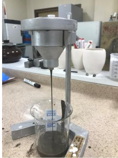
Şekil 4.31 Fordcup5 yardımıyla geopolimer karışımlarının akış sürelerinin belirlenmesi.
