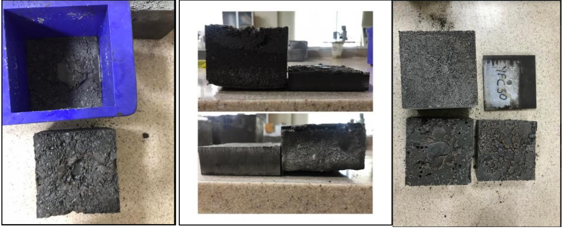
Şekil 3.2 Yüksek fırın cürufu içeren numunelerde yaşanan sorunlar a) Gözenek oluşumunun kontrol edilememesi b) Numunelerde görülen taban ayrışması.
