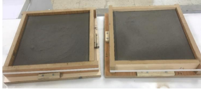
Şekil 3.8 Sıcak levha yöntemi ile ısı iletkenlik analizi yapılmak üzere hazırlanan 30x30x5cm boyutlarındaki numuneler.
