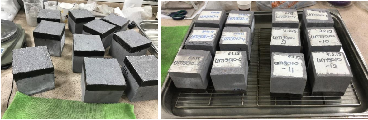
Şekil 3.9 Yüzeyleri parafin ile kaplanan numuneler ile kılcallık analizi.
