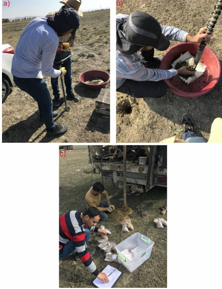
Resim 3.2 a) El burgusu ile numune alınması. b) Alınan numunenin bir kaptta toplanması c) Numunelerin poşetlenmesi ve deney föyüne kaydedilmesi.
