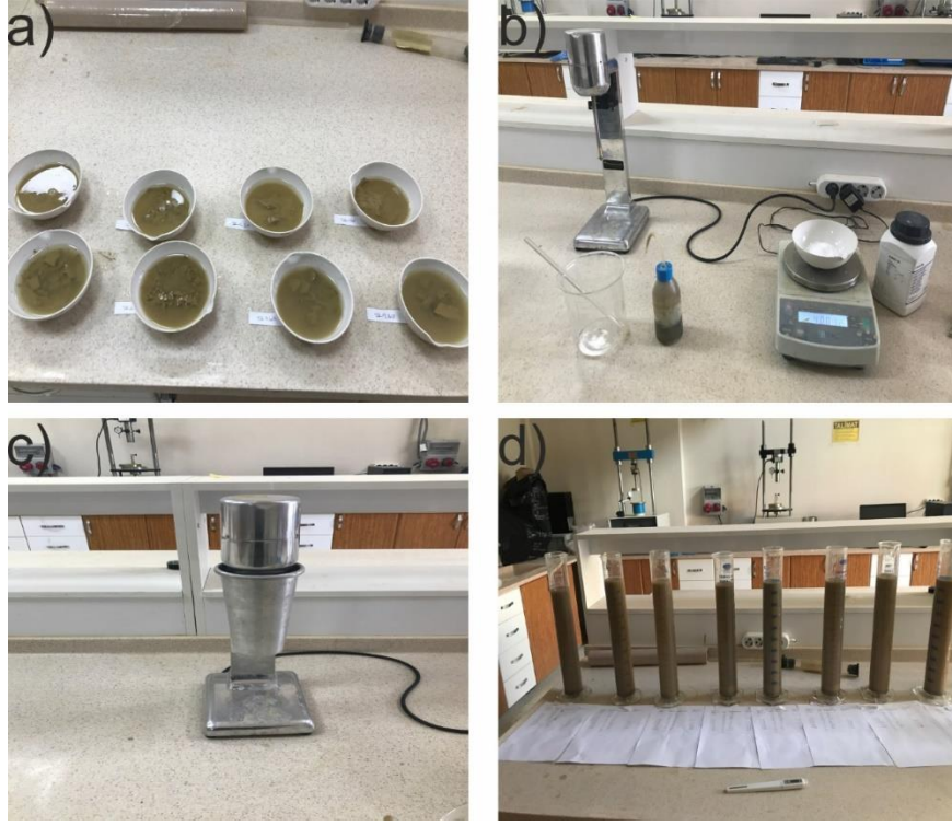
Resim 3.4 a) Numunelere sodyum meta hekzafosfat eklenmesi. b) Deney seti. c) Numunelerin mikser yardımıyla karıştırılması. d) Hazırlanan numunelerin okumalarının yapılması.
