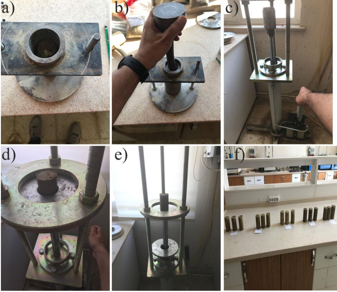
Resim 3.7 a) Numunenin sıkıştırma kabına konulması b) Statik baskıyla numunenin sıkıştırılması c-d-e) Kriko yardımıyla numunenin çıkartılması f) Numunenin hazır hale getirilmesi
