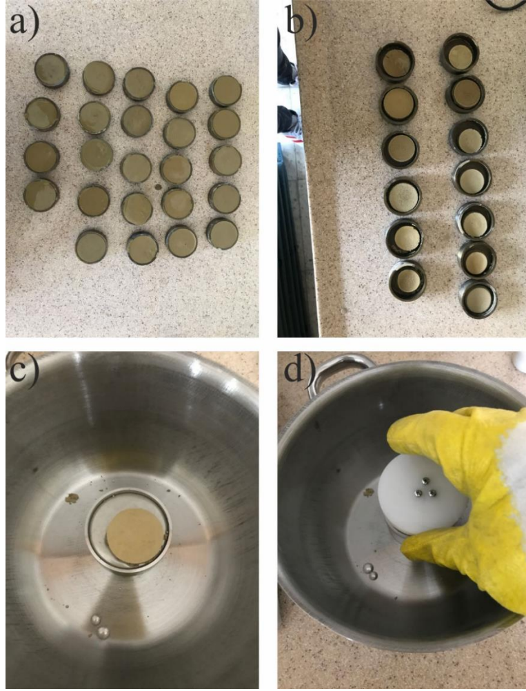
Resim 3.6 a) Numunenin hazırlanması b) Etüvde kurutulan numune c) Etüvden alınan numunenin cıva dolu kaba konulması d) Aparat yardımıyla cıvanın taşırılması
