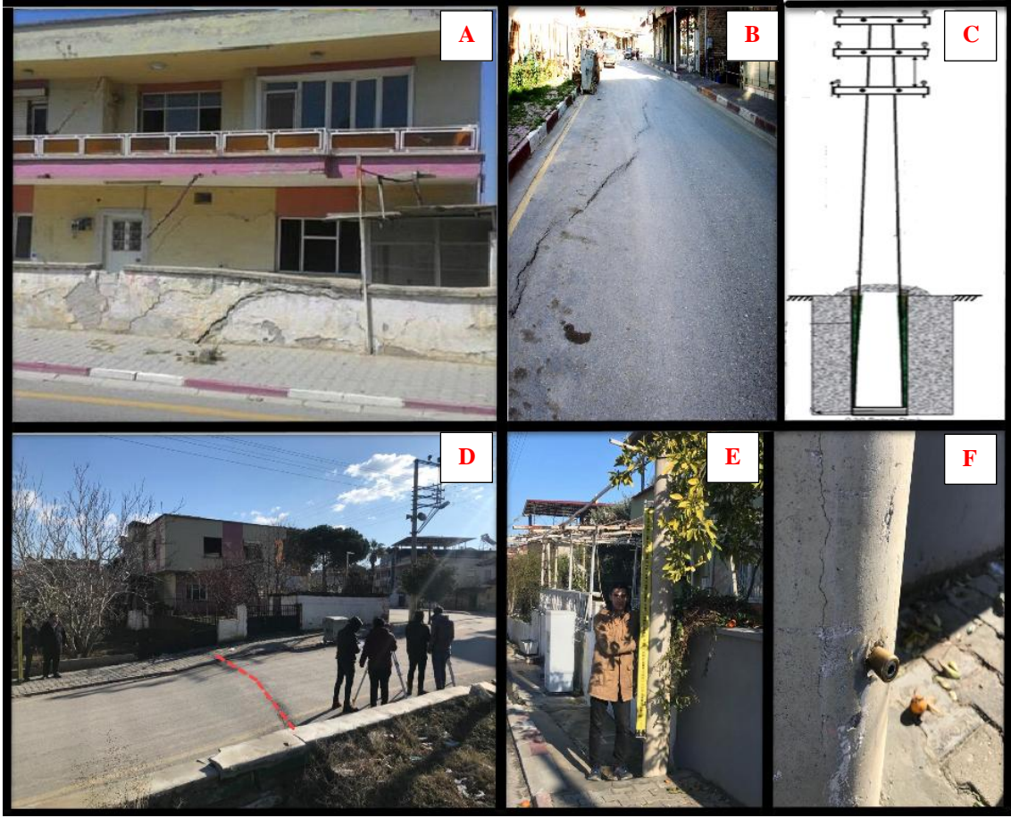
Şekil 5.1 Sarıgöl ilçe merkezinde yüzey deformasyonları (A,B,D) ve tesis edilen RS noktaları (C,E,F).
