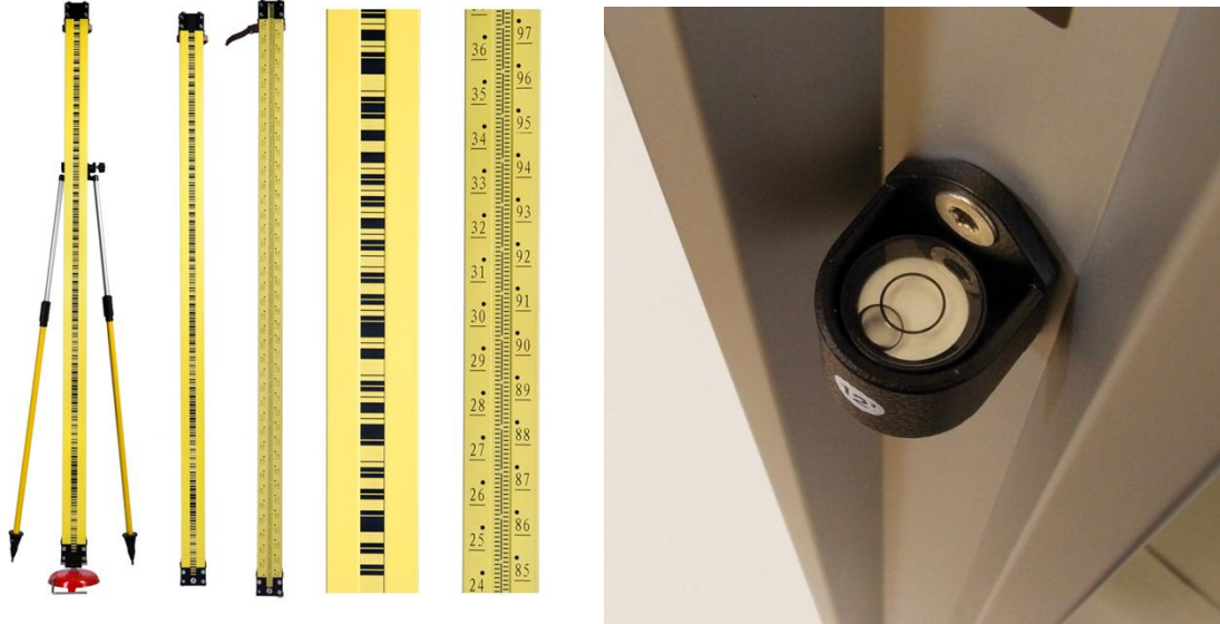
Şekil 4.1 İnvar mira ve mira düzeçi.
