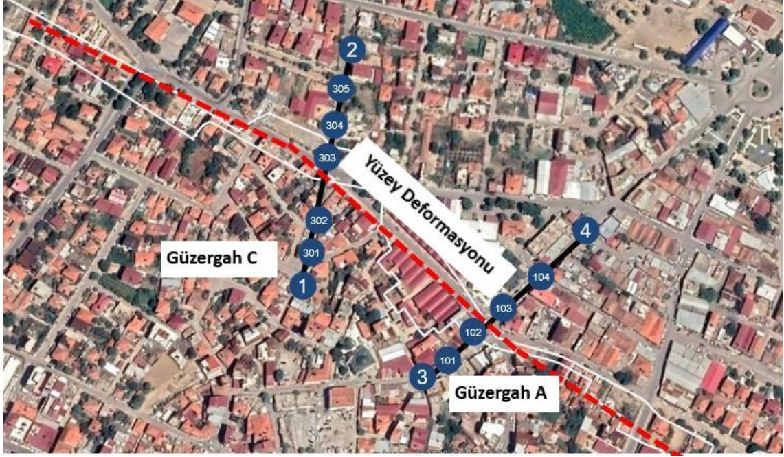
Şekil 5.2 Beyaz çizgi yerleşime riskli alanı, kırmızı çizgi yüzey deformasyonunu, siyah çizgiler belirlenen güzergâhları, numaralar direk yerlerini göstermektedir.
