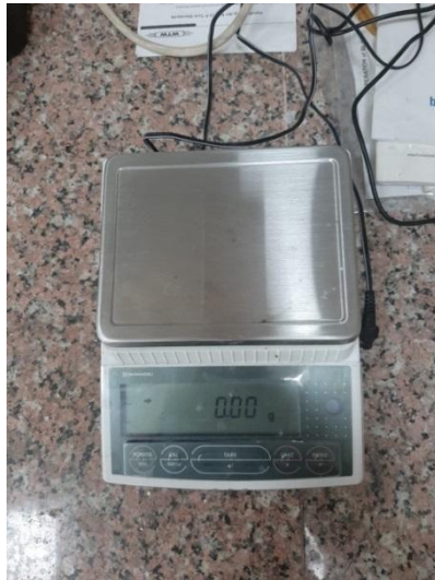
Resim 3.5 Tartımda kullanılan SHIMADZU marka BL3200H model hassas terazi.
