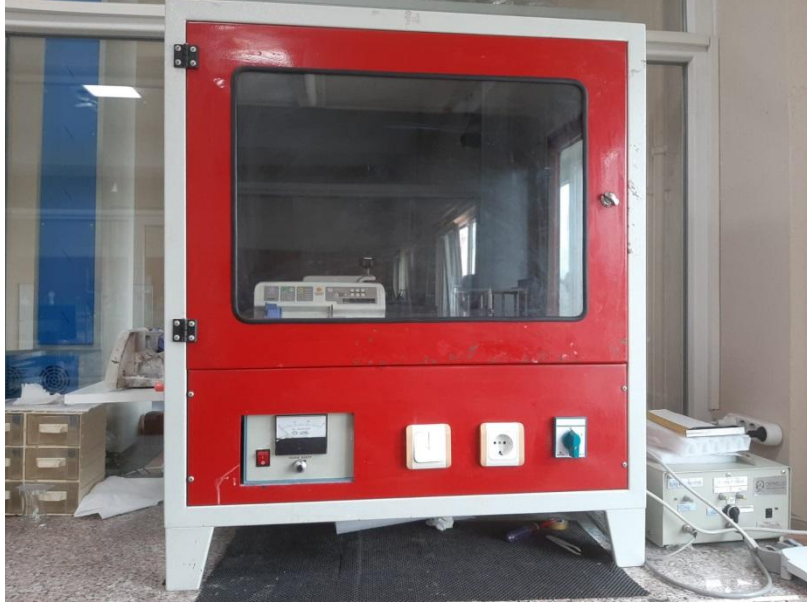
Resim 3.6 Nanolif üretiminde kullanılan elektroęirme cihazı.
