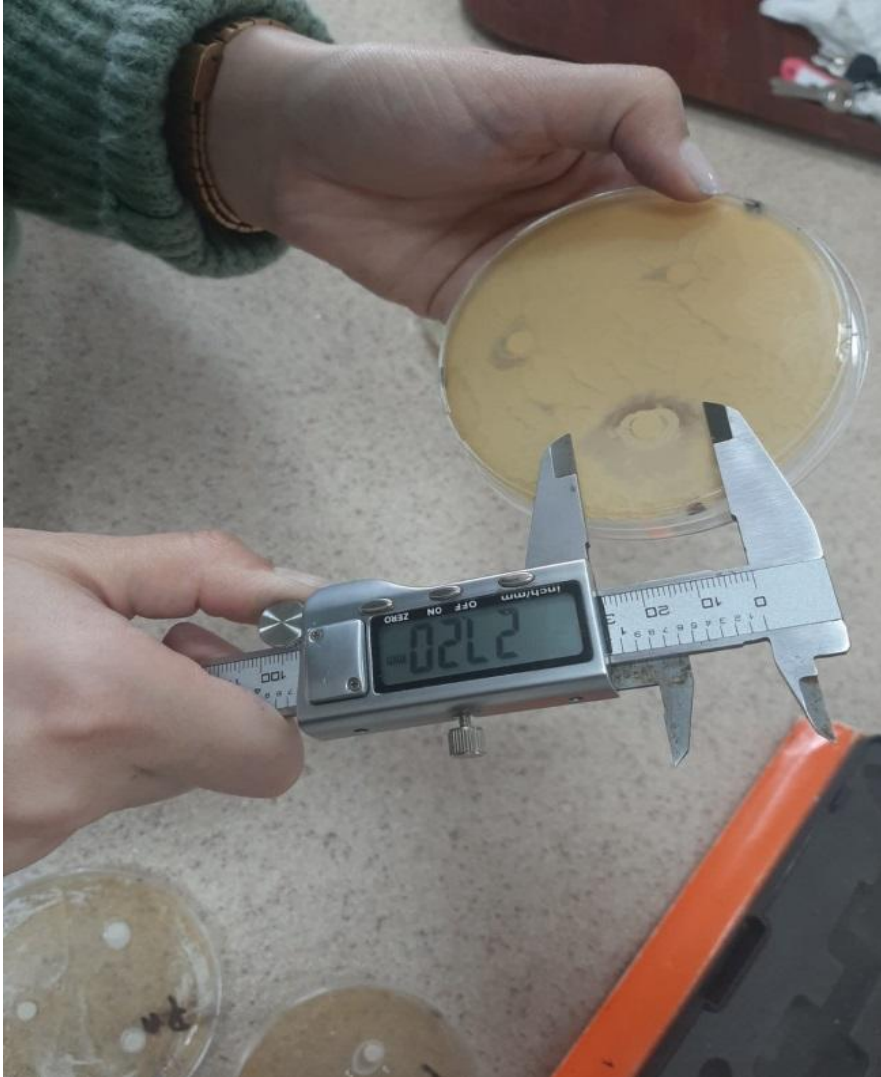
Resim 4.2 Disk difüzyon yöntemiyle yapılan antifungal test sonucu oluşan zon çapının dijital kumpas ile ölçümü.
