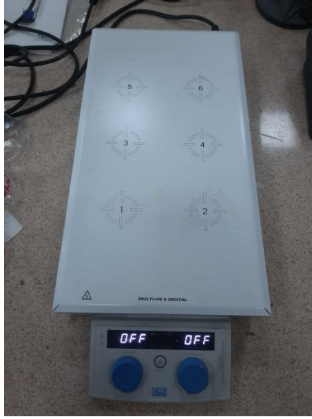
Resim 3.4 Karıştırma için kullanılan Multi-HS 6 DIGITAL marka altılı karıştırıcı.
