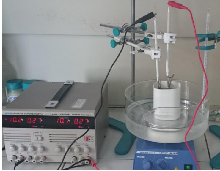
Şekil 3.1 Ti yüzeyinde nanotüp yapıda TiO_2 'ler oluşturmak için anodik yükseltgenme işleminin uygulandığı iki elektrotlu sistemin resmi.
