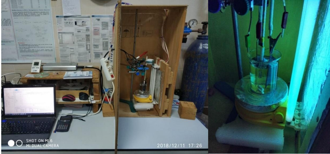
Şekil 3.3 FEK ve EK deneylerin gerçekleştirildiği sistemin düzeneği. Sağ taraftaki resimde sistem ışık açıkken görülmektedir.
