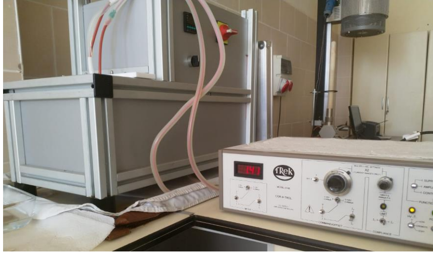
Resim 3.6 Kutuplama işleminde kullanılan Trek Model 610E kutuplama cihazı ve yağ banyosu.
