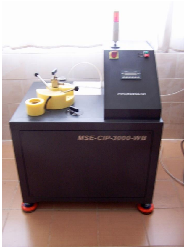
Resim 3.3 MSE-CIP-3000-WB markalı soğuk izostatik pres.
