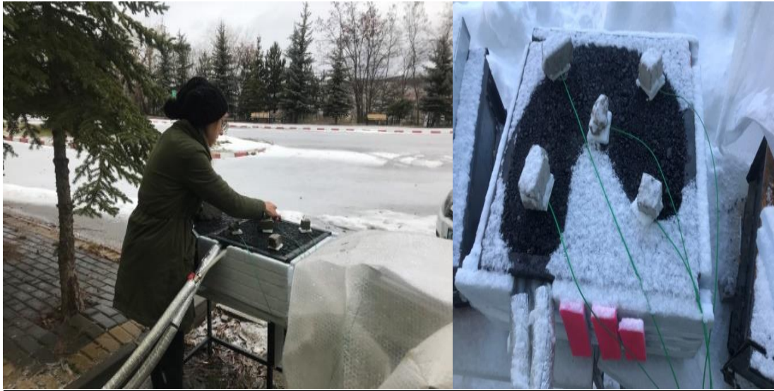
Resim 3.7 Termocupl ile asfalt yüzey sıcaklıklarının alınması.
