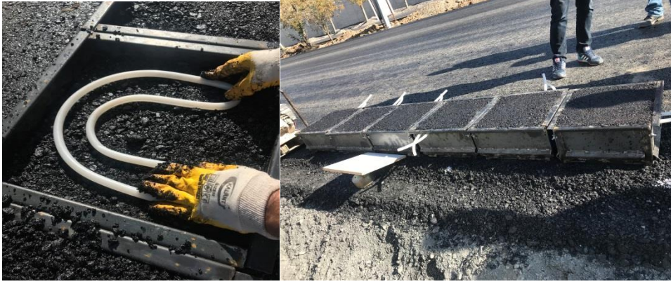
Resim 3.2 Asfalt numunelerin hazırlanması.
