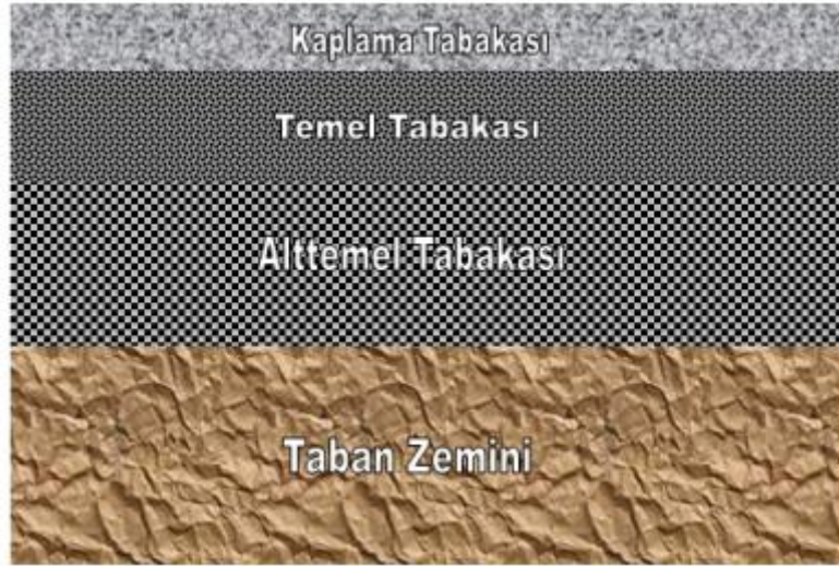
Şekil 2.1 Tipik bir esnek yol enkesiti.
