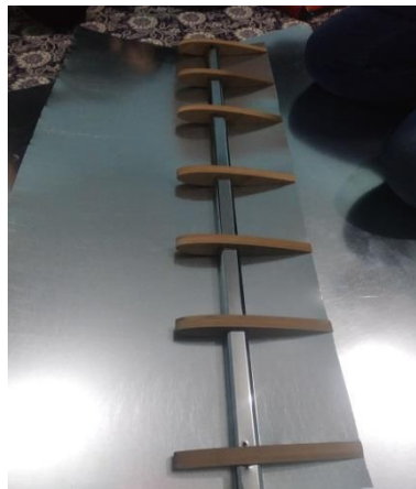
Resim 4.1 Darrieus kanadının iskelet aşaması.
