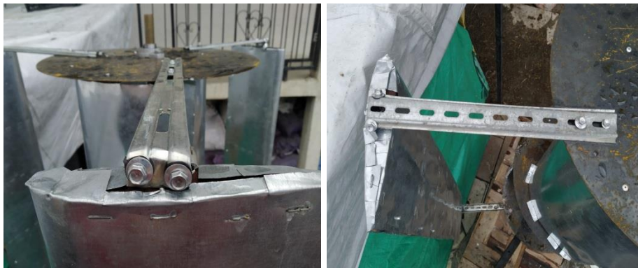
Resim 4.4 Darrieus ve Savonius kanatlarının birleşimi.
