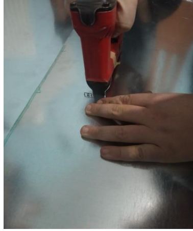
Resim 4.2 Darrieus kanat iskeletinin sac malzemeye zımbalanması.
