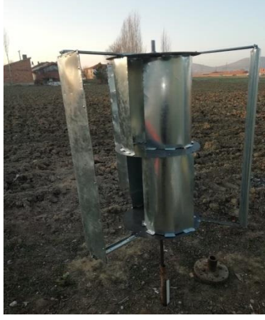
Resim 4.5 Hibrit dikey rüzgâr türbininin son hali.
