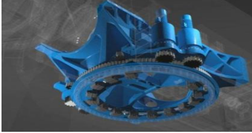
Şekil 2.21 YAW (yön saptırma) mekanizması (Kayn.-6)
