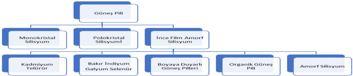
Şekil 2.30 Kullanılan Malzemeye Bağlı Olarak Farklı Güneş Pili Türleri (Swami 2012).
