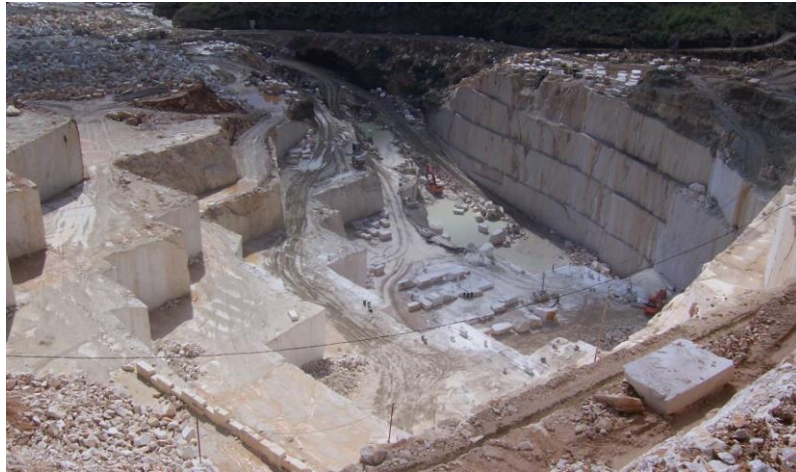
Ek 3: Yamaç tipi bir doğal taş ocağının ova tipi doğal taş ocağına dönüşmesi (Kaynak: Kulaksız, 2012)
