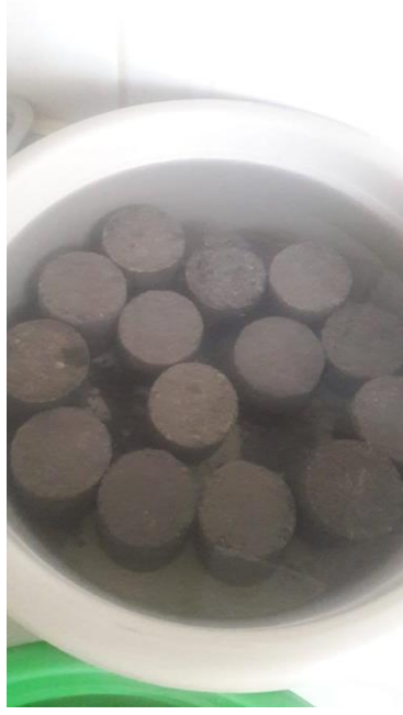
Resim 3.16 Donma-çözölmeye tabi tutulan suda bekleyen silindir harç numuneleri.
