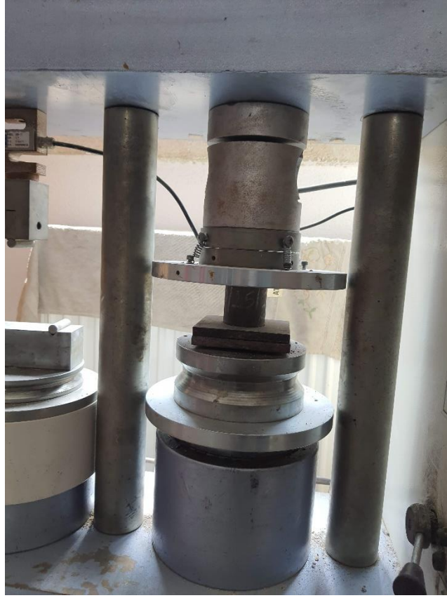
Resim 3.17 Basınç dayanım testine tabi tutulan silindir harç numuneleri.
