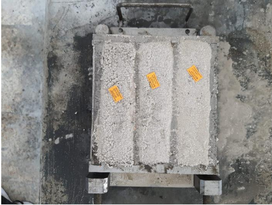
Resim 4.1 Dökümü yapılan harç numuneleri.
