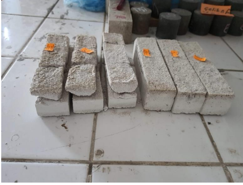
Resim 4.2 Kalıptan çıkarılan ham perlit-YFC harç numuneleri.
