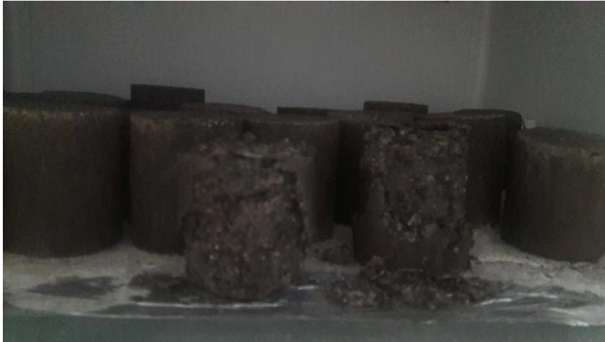
Resim 3.15 Donma-çözölmeye tabi tutulan silindir harç numuneleri.
