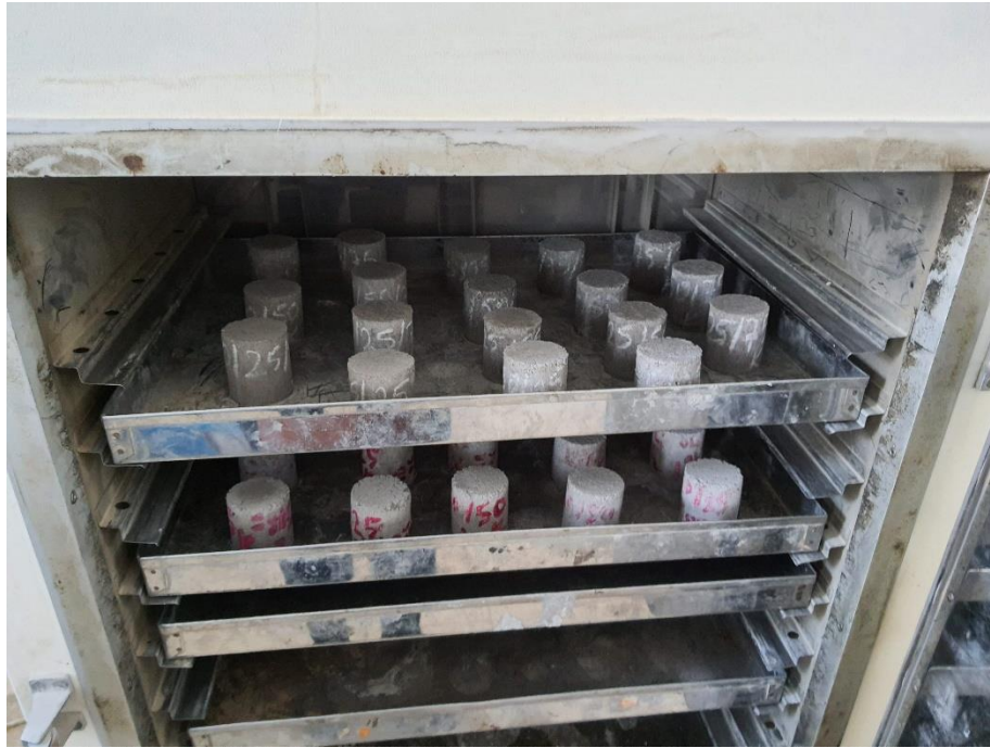
Resim 3.21 Etüv kuru ağırlık için etüvde bekletilen harç numuneleri.
