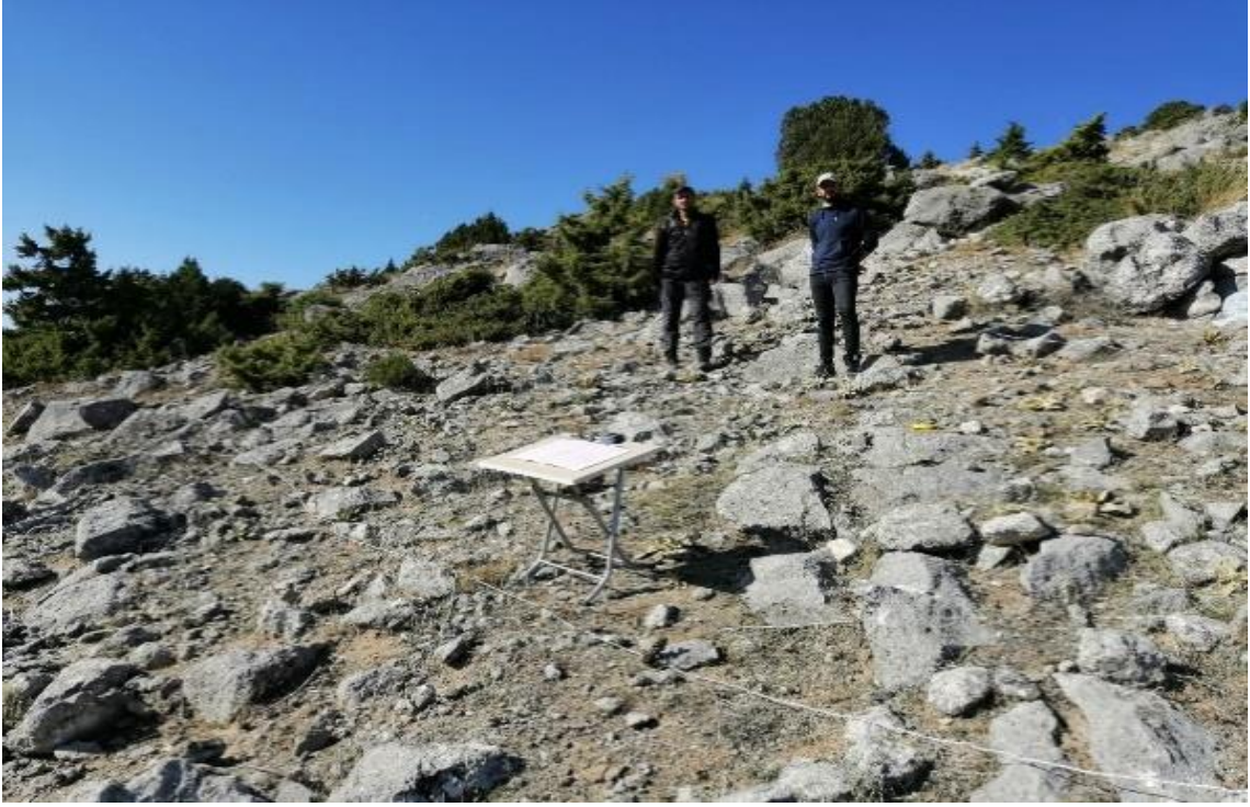
Resim 4.2 Şenler Mermer ocağında pencere etüdü ölçümleri.
