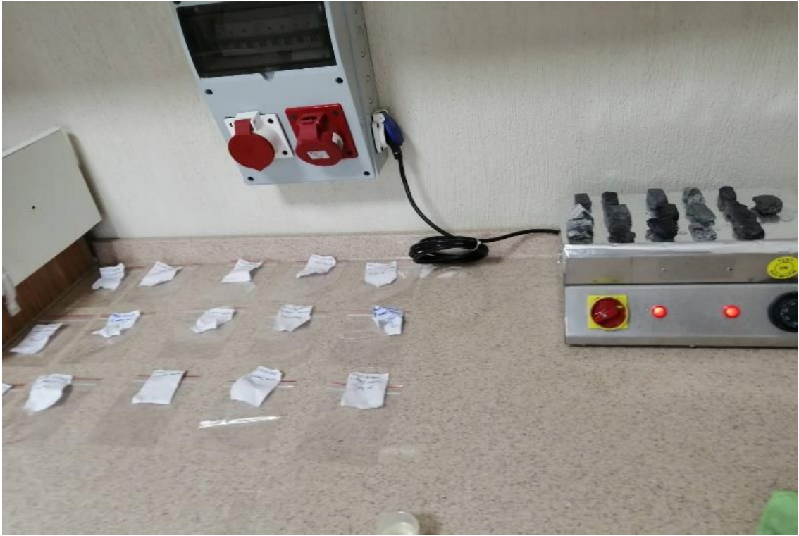
Resim 4.6 Hazırlanan ince kesitlerin ısıtıcı plakada kurutulması.
