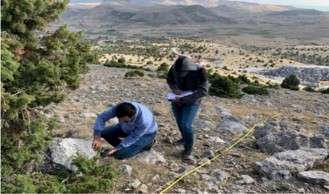
Resim 4.1 Şenler Mermer ocağında hat etüdü ölçümleri.
