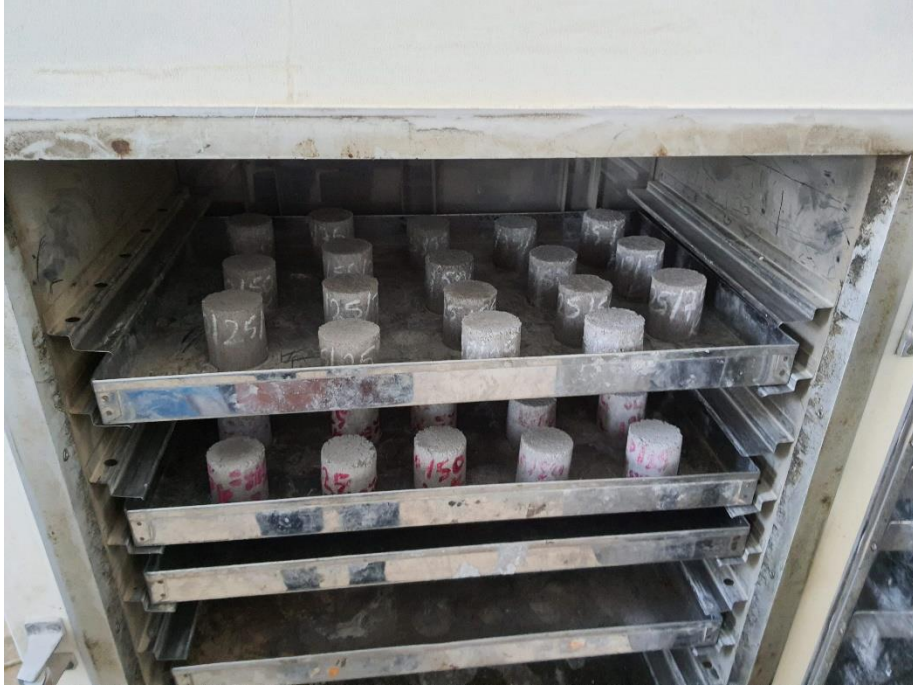
Resim 3.21 Etüv kurusu ağırlık için etüvde bekletilen harç numuneleri.
