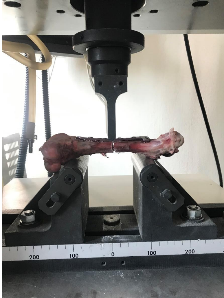
Resim 3.7: Bending Testi sırasında S plak ile tespiti sağlanmış materyal.
