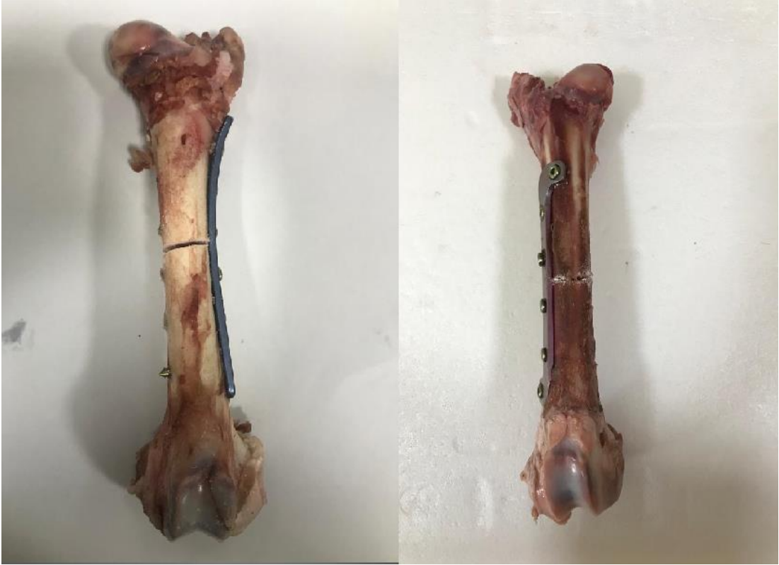
Resim 2.4: Sol tarafta düz plak ile sağ tarafta S plak ile kırık hattı oluşturulmuş, ardından stabilizasyonu sağlanmış femur kemikleri.
