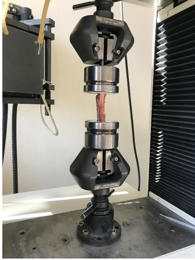
Resim 2.9: Distraksiyon testi için cihaza tutturulmuş S plak tespitli materyal.
