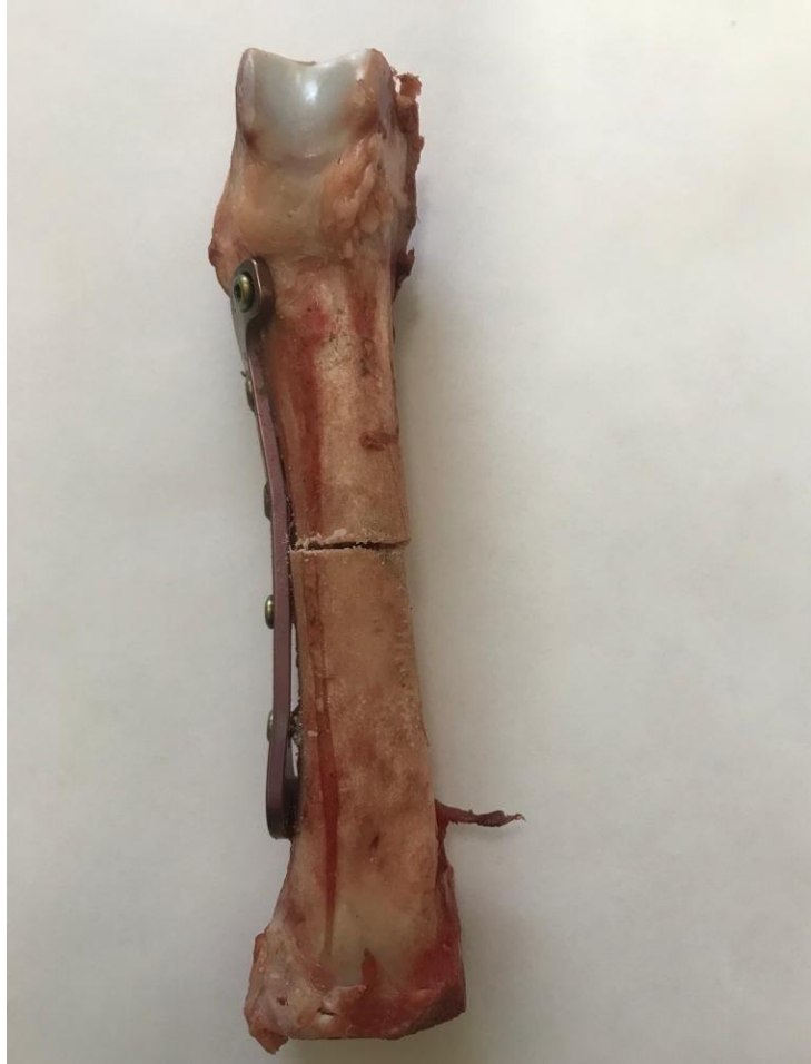
Resim 2.6: Aksiyel kompresyon testi için hazırlanmış olan materyalin görseli.
