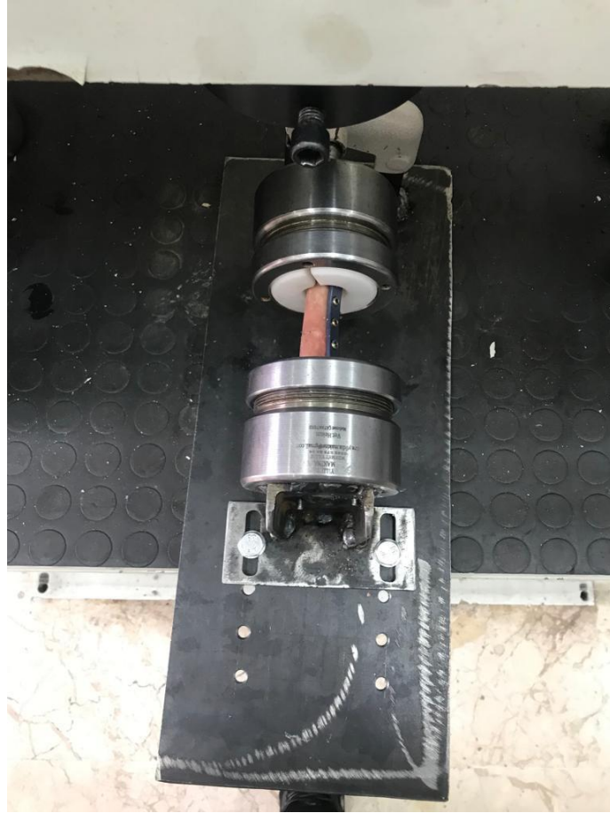
Resim 2.11: Torsiyon (burulma) testleri için hazırlanmış aparat ve aparata test için tutturulmuş, düz plak ile tespiti yapılmış materyal.
