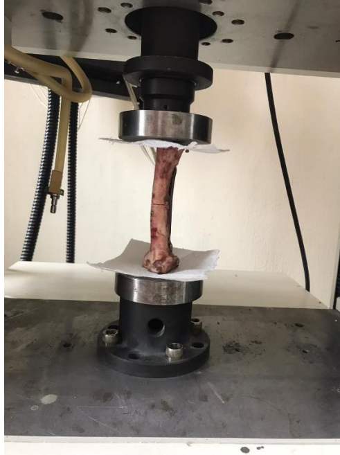
Resim 3.1: Aksiyel Kompresyon testi sırasında S plak ile tespiti saęlanmış materyal.
