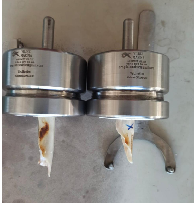
Resim 2.8: Distraksiyon testi için özel üretilen kemik tutma aparatları.
