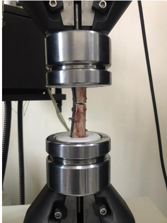
Resim 3.4: Distraksiyon (Gerilme) testi sırasında dz plak ile tespiti saęlanmış materyal.
