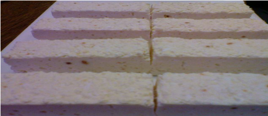
Resim3.5 Numunelerin sinterleme sonrası görünüşü
