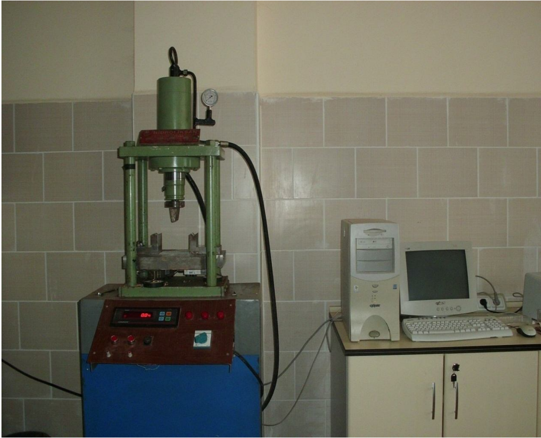
Resim 3.3 Üç nokta eğme dayanımı cihazı
