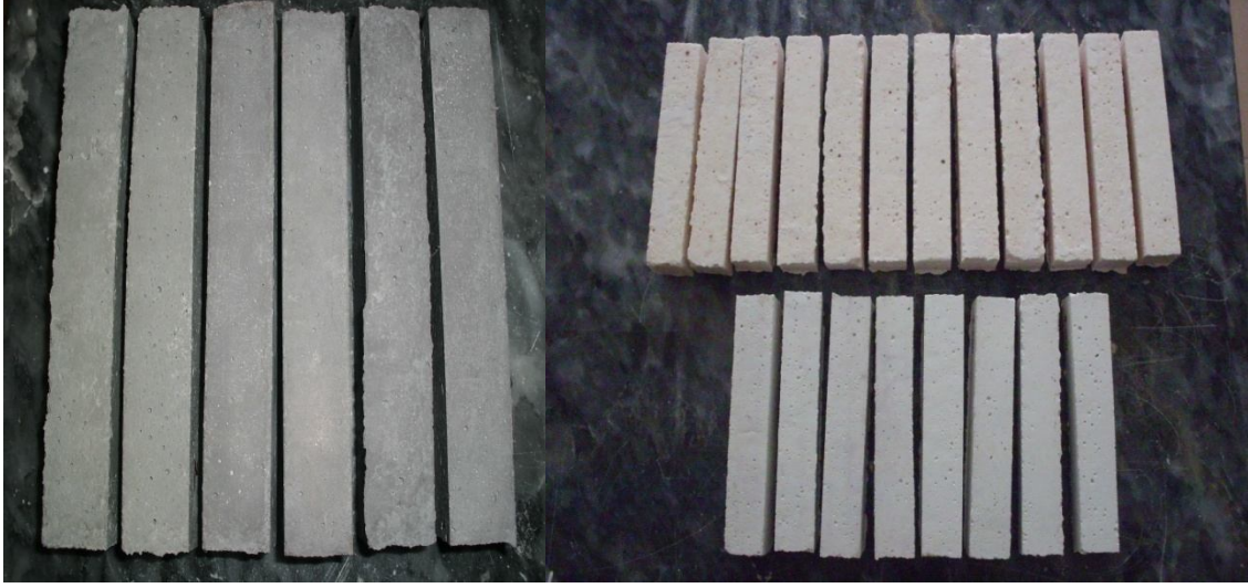
Resim 3.2 Kurutma ve sinterleme sonrası numunelerin görünüşü
