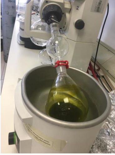
Resim 3. 2: Rotavaporda ekstre solventinin buharlaştırılması işlemi
