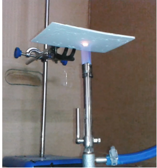
Şekil 2. UL94 alev test standardı
