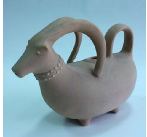
Resim 57. Andezit Katkılı Döküm Çamuru ile Hazırlanan Formların Alçı Kalıpta Şekillendirilmiş ve Daha Sonra 1160 °C de Pişirilmiş Görüntüleri
