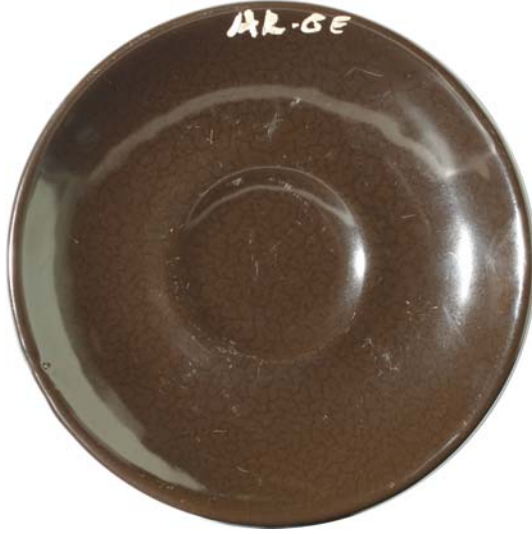
Resim 60. Andezitin Güral Porselen Fabrikasında Yapılan 1160 °C' deki Sır Uygulaması ve Detayı
