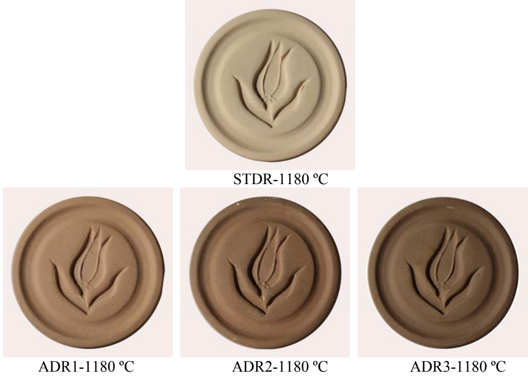
Resim 55. Standart ve Andezit Katkılı Döküm Çamurlarının 1180 °C' deki Sırsız Pişme Renkleri
