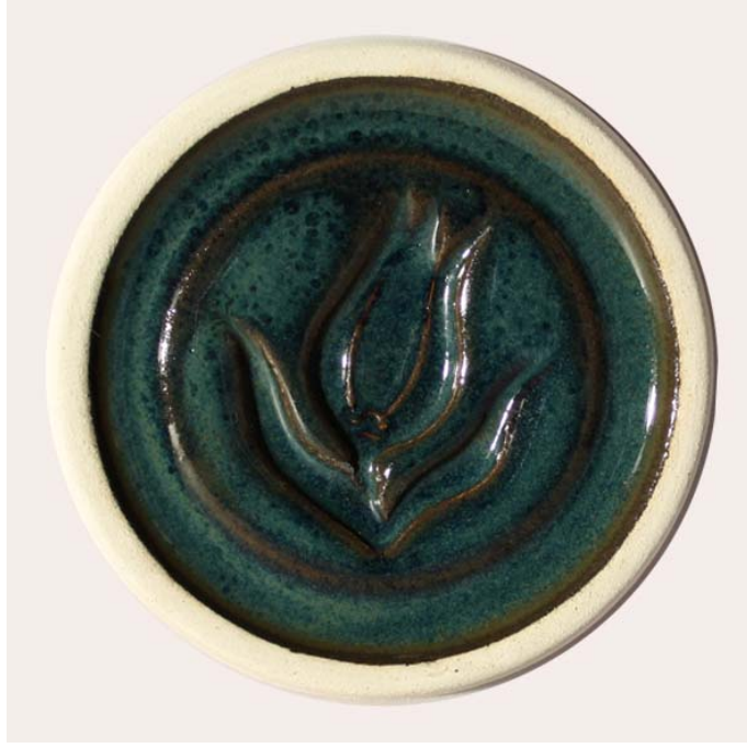
Resim 73. Andezit, Metal Oksit ve Seramik Boyalarla Oluşturulan Sır Örneği
