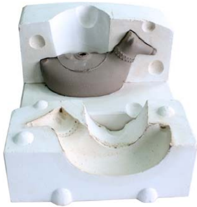
Resim 57. Andezit Katkılı Döküm Çamuru ile Hazırlanan Formların Alçı Kalıpta Şekillendirilmiş ve Daha Sonra 1160 °C de Pişirilmiş Görüntüleri
