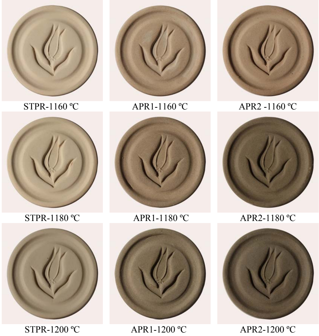
Resim 50. Standart ve Andezit Katkılı Plastik Çamurların 1160, 1180 ve 1200 °C 'deki Sırsız Pişme Renkleri
