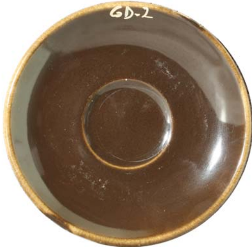
Resim 59. Andezitin Güral Porselen Fabrikasında Yapılan 1150 °C' deki Sır Uygulaması ve Detayı
