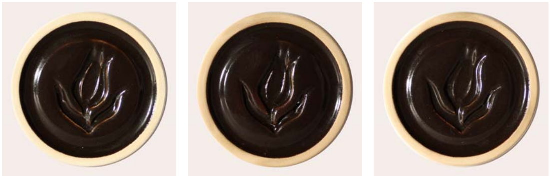
Resim 67. Andezite ZnO Katkısıyla Oluşturulan Sırlar
