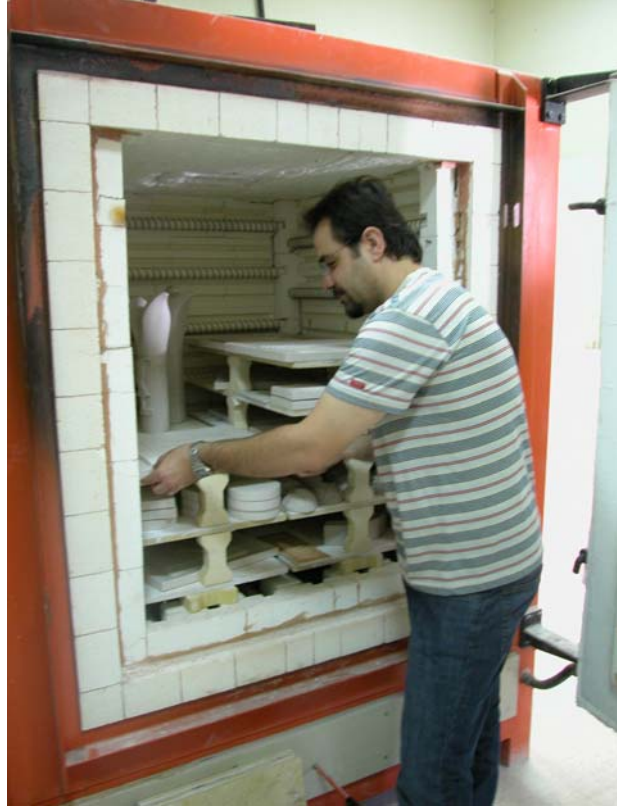
Resim 78. Bisküvi Pişirimi İçin Fırının Yerleştirilmesi
