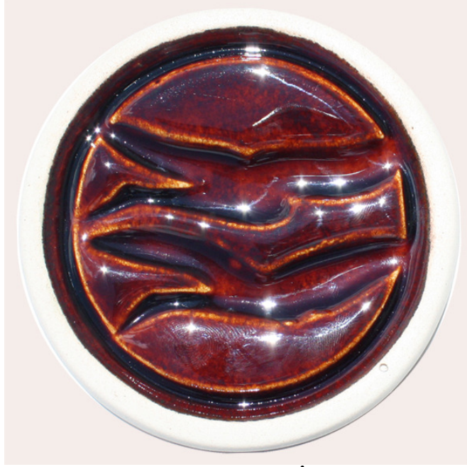
Resim 122. Bazalt, Demir Oksit ve Mangan oksit İle Renklendirilen Sırın Pişme Rengi
