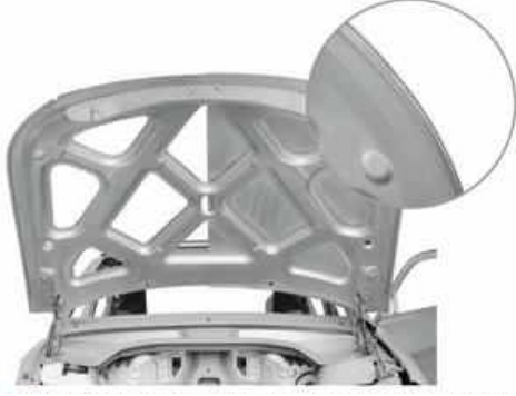
Şekil 10. Yeni nesil motor ön kaput tasarımı (Lösch et al. 2009)
