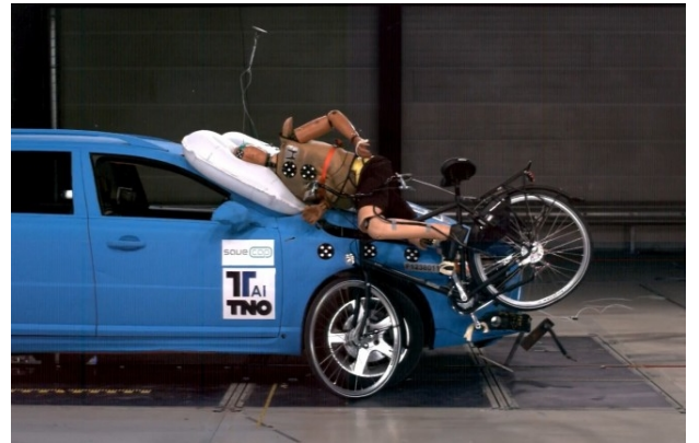
Şekil 5. Yayanın başı ile kaput arasındaki deformasyon boşluğu (Int Kyn. 4)
